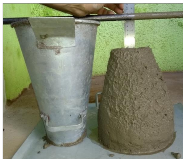
Figura 3.7 - Ensaio de consistência por abatimento do tronco de cone ( slump test )
