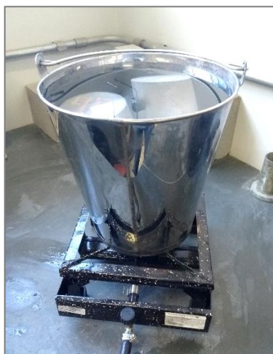
Figura 3.13 - Submersão e ebulição dos corpos de prova
