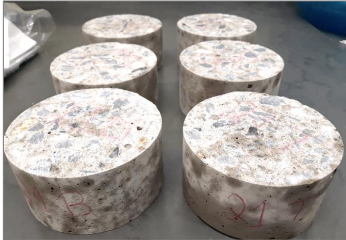
Figura 3.15 - Fatias de concreto obtidas após o corte dos CPs
