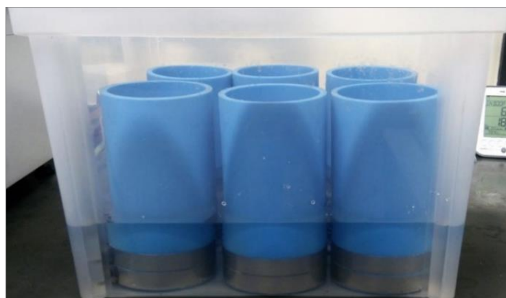
Figura 3.19 - Teste de estanqueidade dos conjuntos do ensaio
