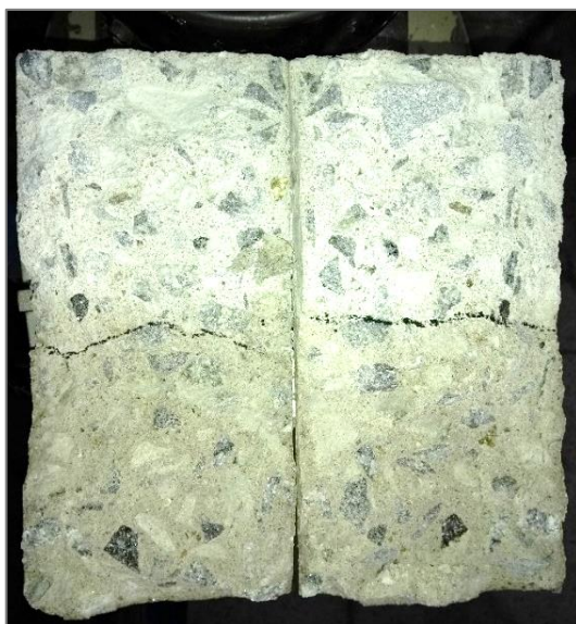
Figura 3.12 - Rompimento diametral e medição das alturas de ascensão capilar
