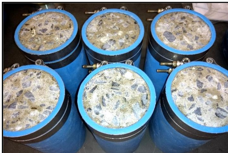
Figura 3.18 - Amostras no interior das camisas de silicone
