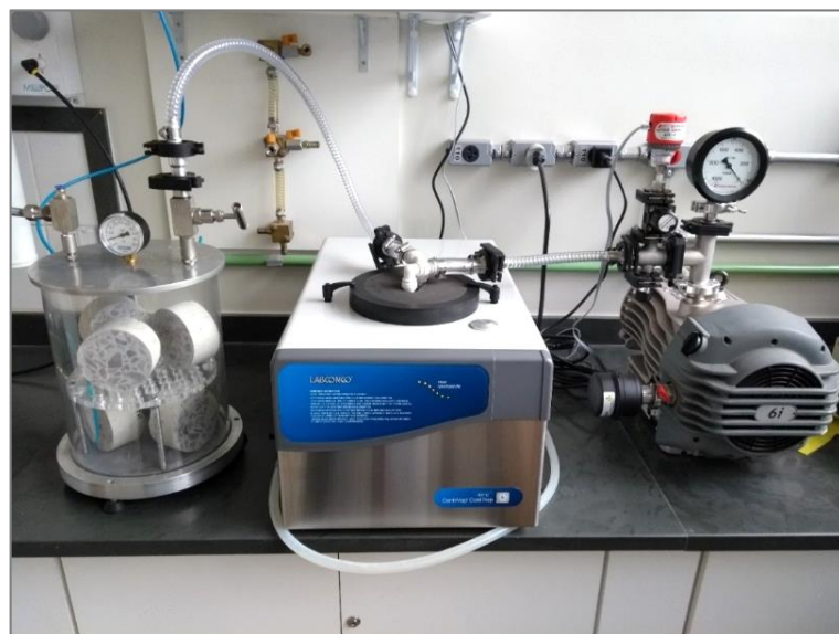
Figura 3.16 - Conjunto: câmara de vácuo, ColdTrap e bomba
