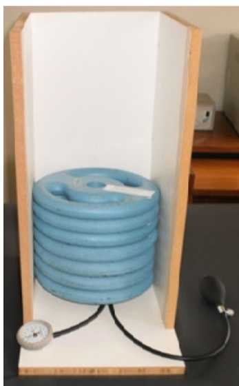
FIGURA 4 - Anilhas mantidas empilhadas pelo suporte de madeira e sobre o efigmomanômetro modificado para ser calibrado
