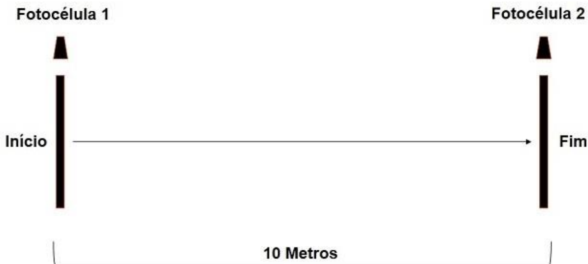
Figura 8 - Teste em linha reta para cálculo do DMDD
