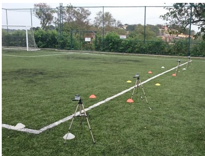
Figura 5 - Fotocélulas posicionadas para o teste em linha reta
