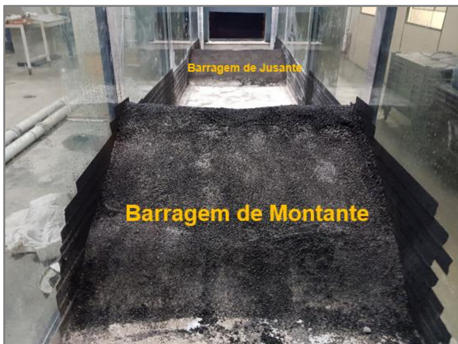
Figura 5.11: Modelos de barragens em cascata preparados no canal.
