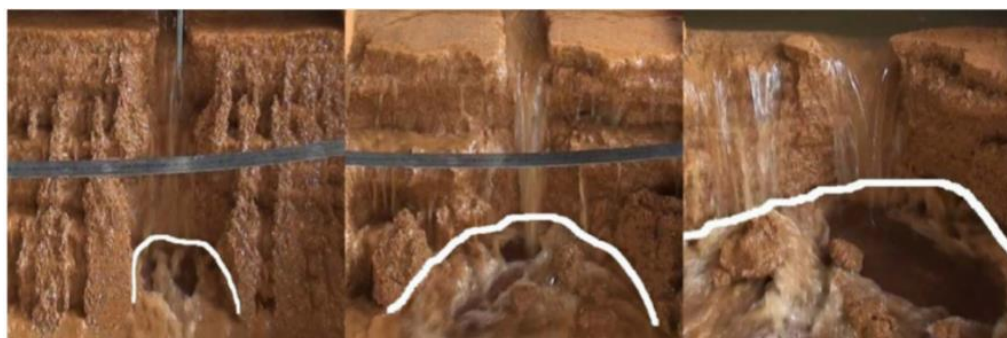
Figura 4.9: Erosão do tipo côncava de corte pela crista.
