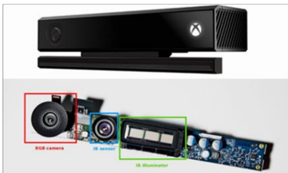
Figura 5.12: Scanner a laser Kinect II com câmera RGB, sensor IR e Iluminador infravermelho.
