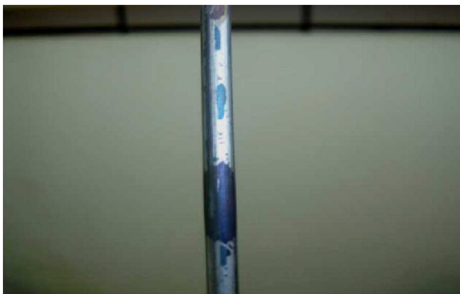
Figura 3.12: Corpo de prova após ensaio de tração - ocorrência de carepa azul.
