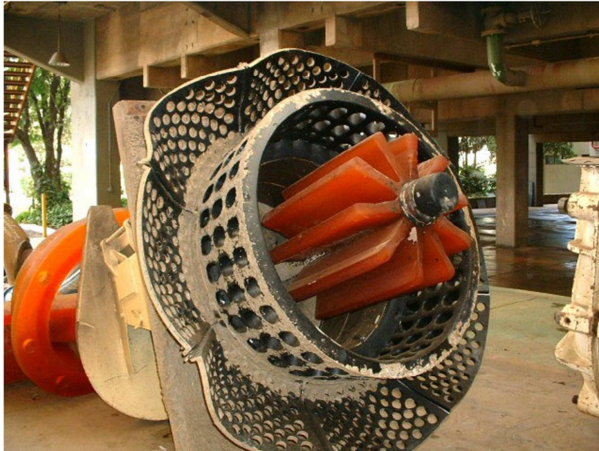
Figura 3.3- Conjunto rotor, difusor e capa do difusor das células Wemco.
