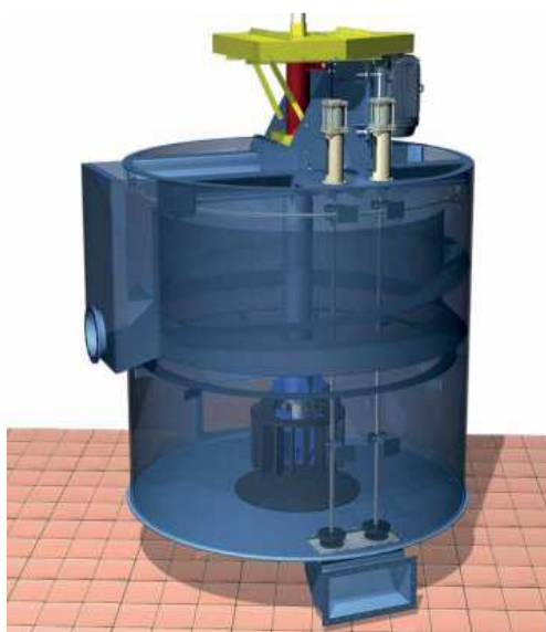
Figura 3.8 – Célula tanque: desenho esquemático modelo RCS da Metso.
