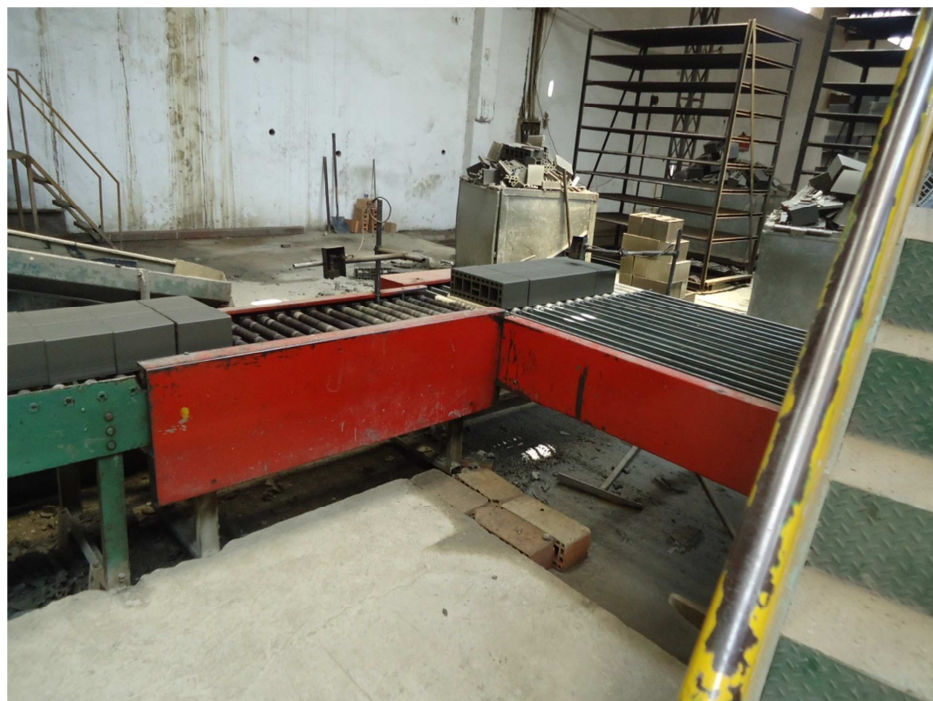
Figura 8 – Material seguindo para pré-forno, foto retirada na cerâmica Jacarandá. Fonte: Autor.
