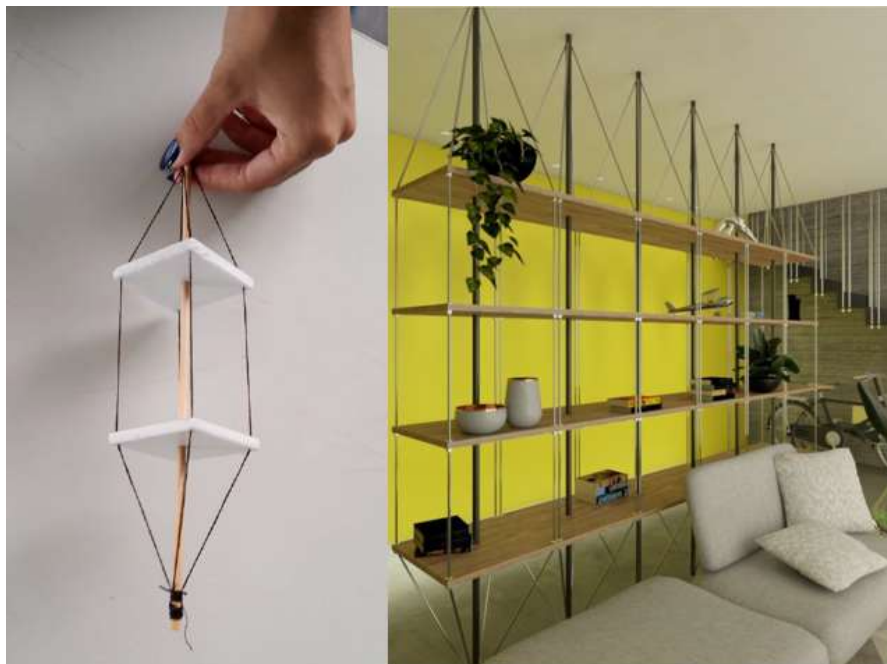
Figura 51 - Projeto de estante desenvolvido a partir do sistema estrutural de pilar vagonado, obtido pela associação de placas, cabos e barras
