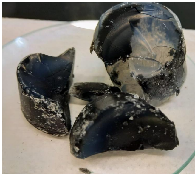
Figura 39 - Amostra com inserção de GO suspenso em etanol, gelificada à 120 °C em reator hermético e com notável heterogeneidade.
