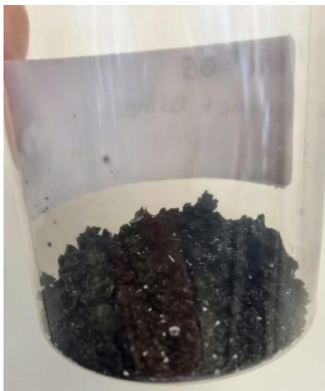
Figura 38 - Partículas de amostra com inserção de GO suspenso em etanol e gelificada à 180 °C em autoclave.
