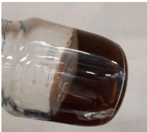
Figura 37 - Amostra homogênea com inserção de GO suspenso em etanol e gelificada à temperatura ambiente durante 27 dias.
