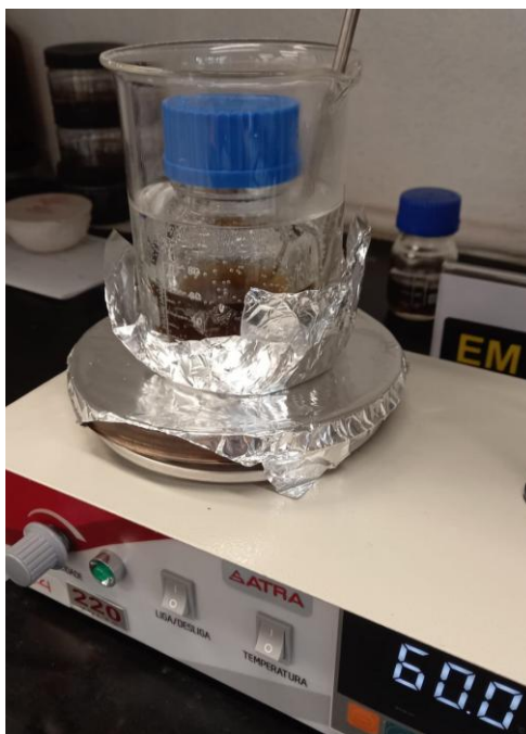
Figura 40 - Amostra (GOE60.a) com inserção de GO suspenso em etanol, gelificando a 60°C em manta térmica com agitação magnética.
