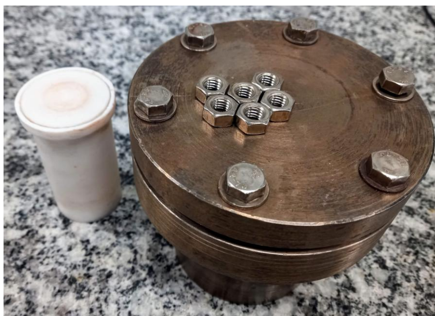
Figura 18 - Recipiente de teflon e autoclave utilizados na gelificação das amostras em forno.
