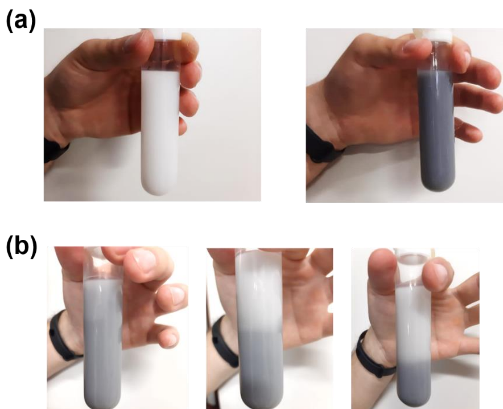
Figura A3. (a) Diferença de cor antes e após a irradiação do sistema contendo etanol e ácido levulínico e (b) gradiente de cor ao longo do tempo após a remoção da tampa do reator, mostrando visualmente a captura dos elétrons acumulados pelo oxigênio atmosférico.
