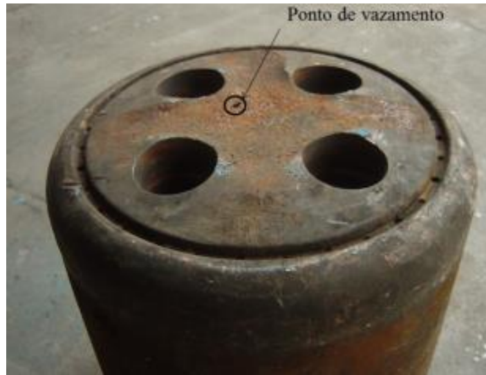
FIGURA 3.18: Bico de lança que falhou por rebote de jato.
