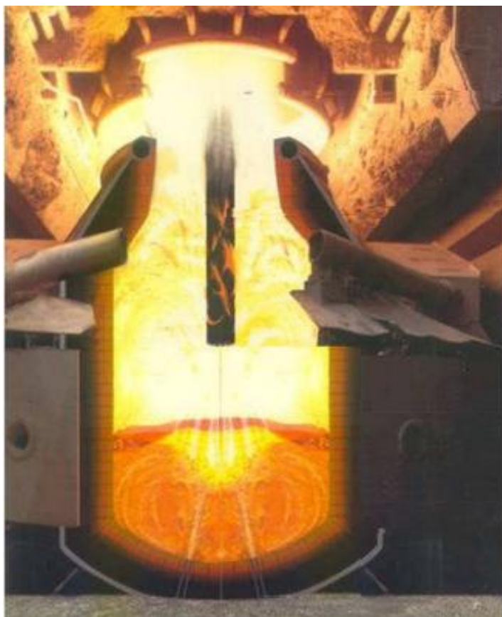
FIGURA 3.9: Desenho esquemático do sopro de oxigênio em convertedor BOF. FONTE: GONÇALVES, 2005.
