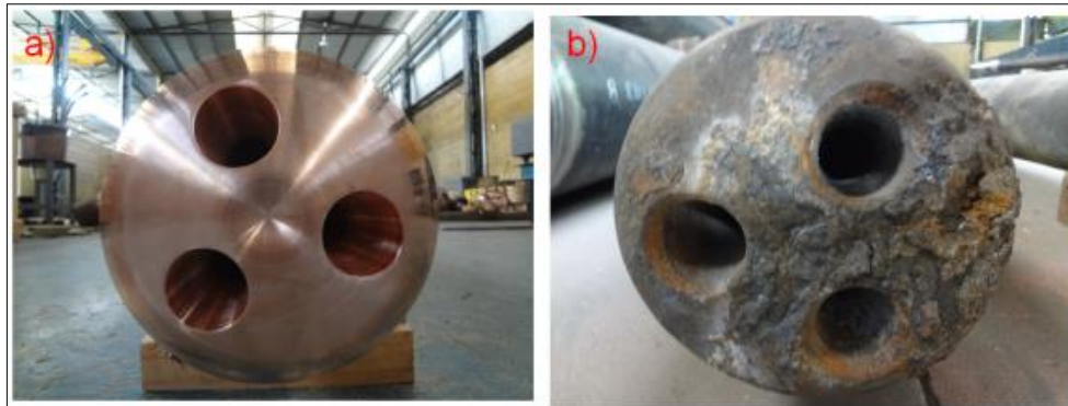
FIGURA 3.20: a) Bico novo; e b) Bico usado com vida de 600 corridas em função do desgaste nos bocais.
