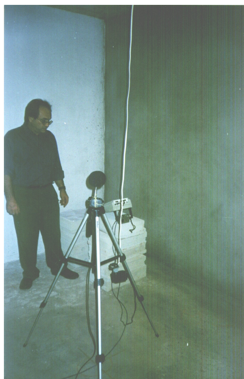
FOTO 5.2 – Medição da absorção das superfícies internas da câmara de ensaio I
