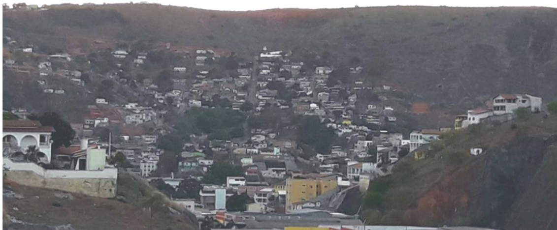
Figura 4.9 – Vista de porção do setor nordeste de Teófilo Otoni, com visada para o eixo de crescimento B da Figura 4.8. Notar que a ocupação se processa sobre porção convexa da vertente (em perfil), em direção a feições côncavas (em planta). À direita e na parte central superior, cicatrizes de escorregamentos recentes, atestando a instabilidade do ambiente ocupado.
