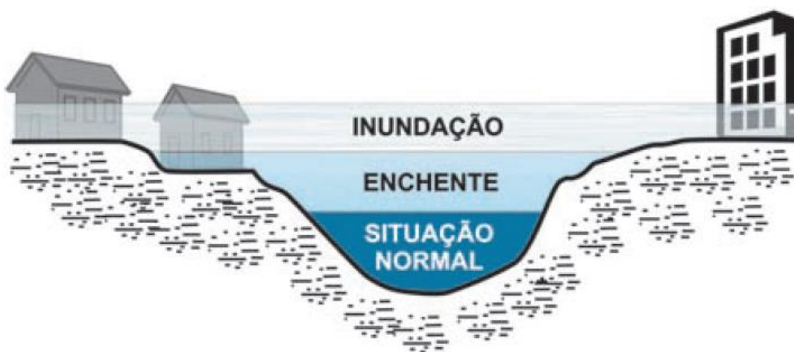
Figura 2.3 – Enchente e inunda o, de acordo com o Minist rio das Cidades/IPT (BRASIL, 2007 apud AMARAL e RIBEIRO, 2009).
