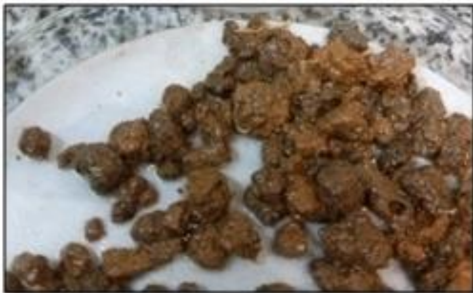
Figura 19. Pré-umedecimento dos agregados para análise de estabilidade. Fonte: Autor.
