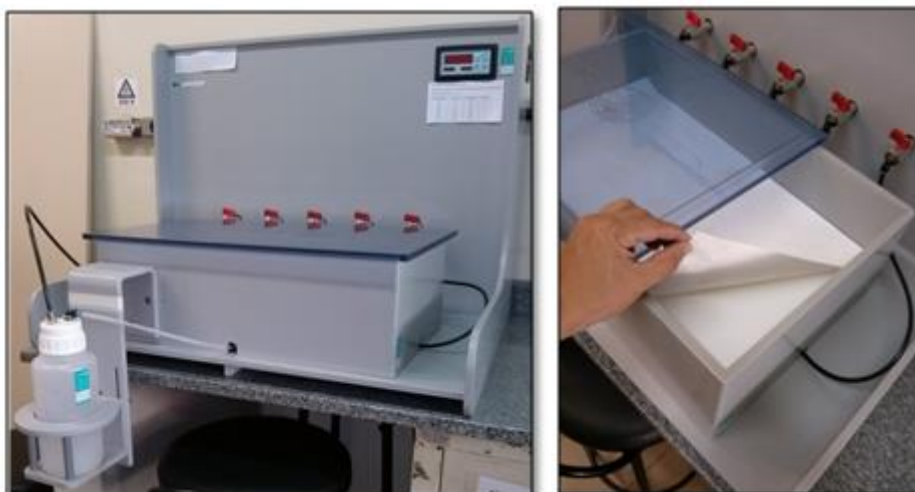
Figura 9. Mesa de tensão e membrana porosa de proteção. Fonte: Autor (Laboratório de Solos e Meio Ambiente do IGC-UFMG).
