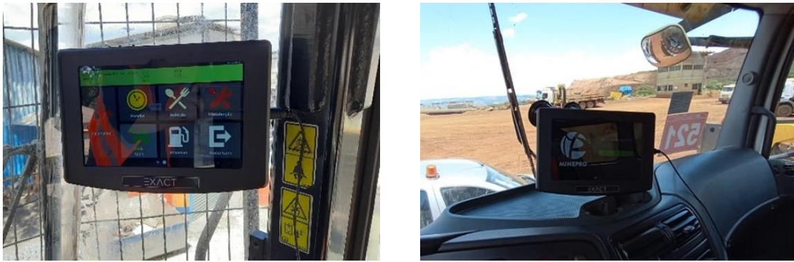
Figura 4: Computador de bordo do sistema de despacho MinePro ® na cabine de uma pá carregadeira (esquerda) e de um caminhão (direita)
