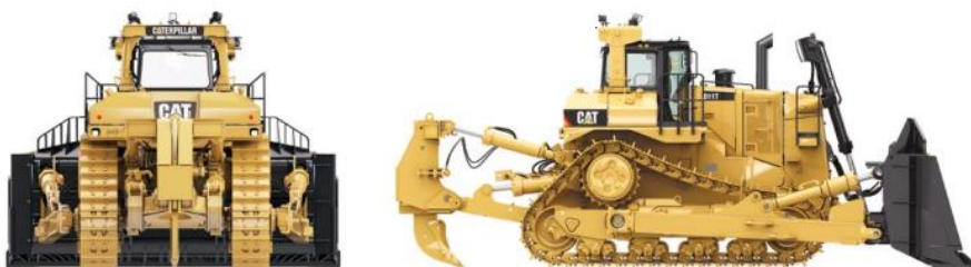
Figura 3: Vista traseira e lateral de um trator de esteiras
