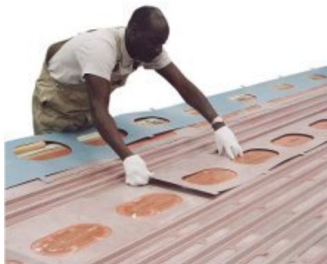
FIGURA 3.21: Colagem de painéis metálicos da asa[28].
