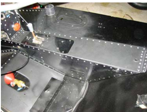
FIGURA 3.20: Veículo-protótipo rebitado (esquerda) [26] e montagem com interferência (direita) [27].
