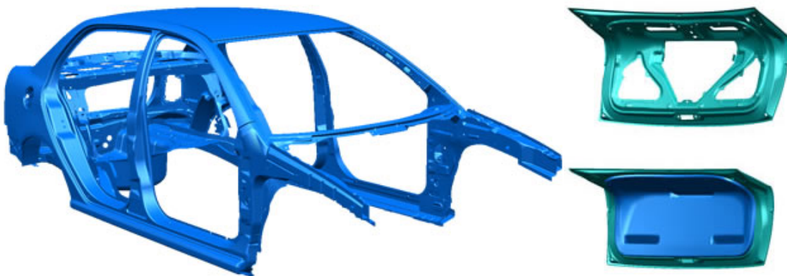
FIGURA 3.11: Uso de múltiplas peças estampada e soldadas para a formação de uma estrutura [12].
