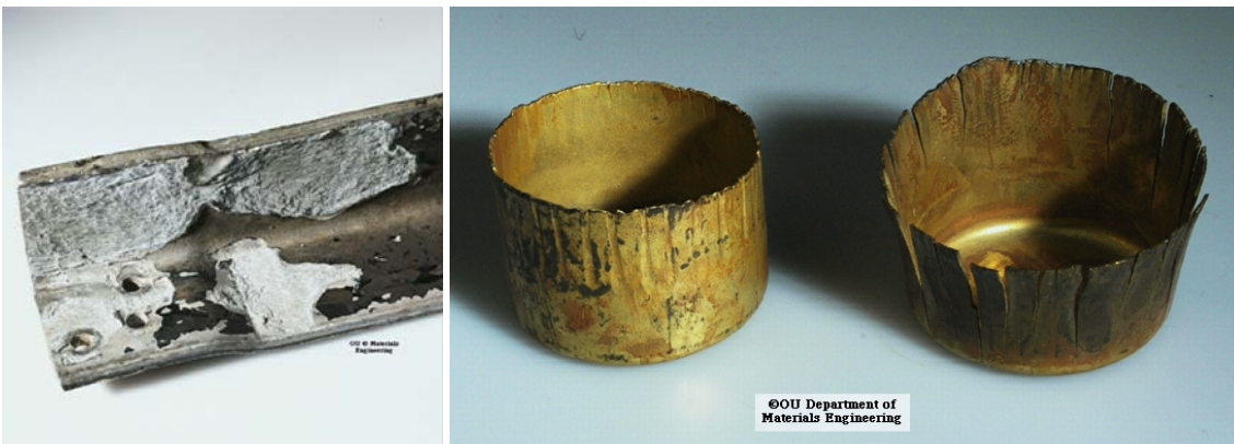
FIGURA 3.6: Corrosão em Alumínio em ambiente salino (esquerda); Corrosão em peça estampada de cobre com tensões residuais (direita) [7].
