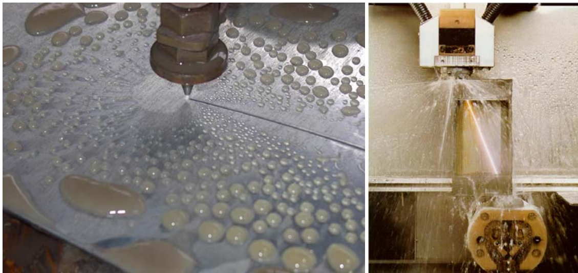
FIGURA 3.18: Corte com jato de água (esquerda) [20] e por eletro-erosão a fio (direita) [21].
