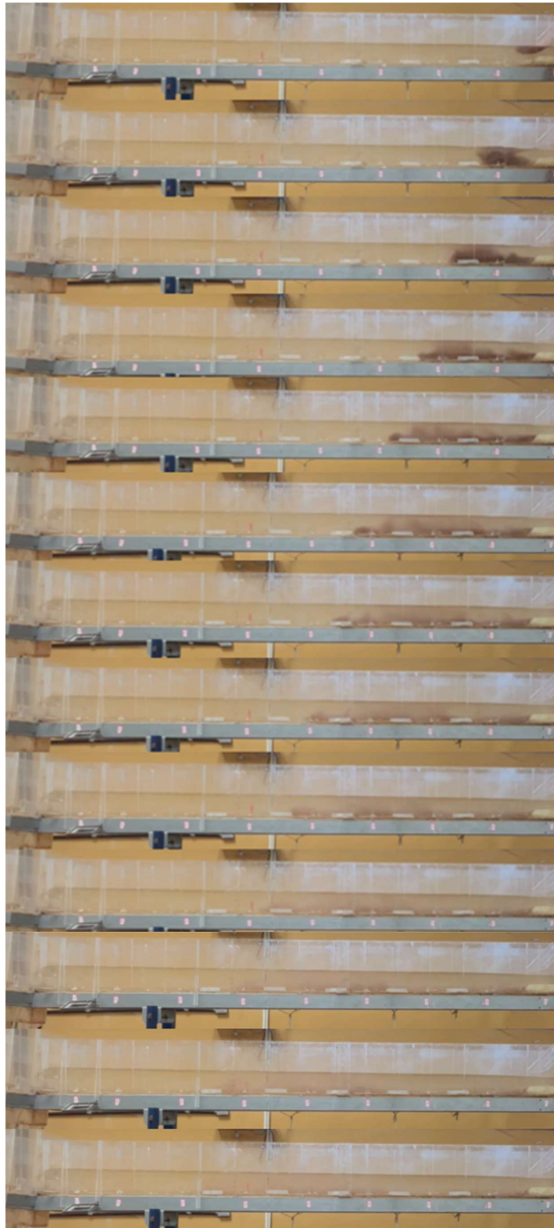
Figura 43 - Deposição de rejeito de minério de ferro na faixa granulométrica 0,125 mm a 0,090 mm no canal com lançamento de 200 g no início do escoamento (fotos a cada segundo).
