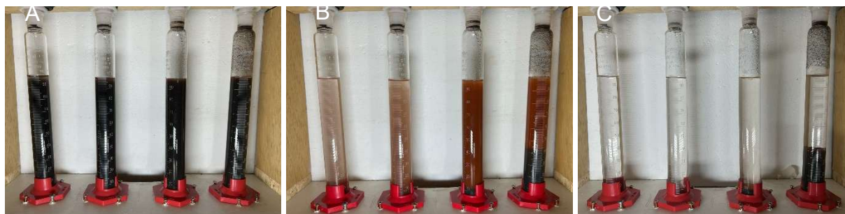
Figura 15 – Análise de velocidade de queda entre (a) o tempo inicial após a mistura homogênea até atingir: (b) a parcela de rejeito acinzentada e (c) clarificação total.
