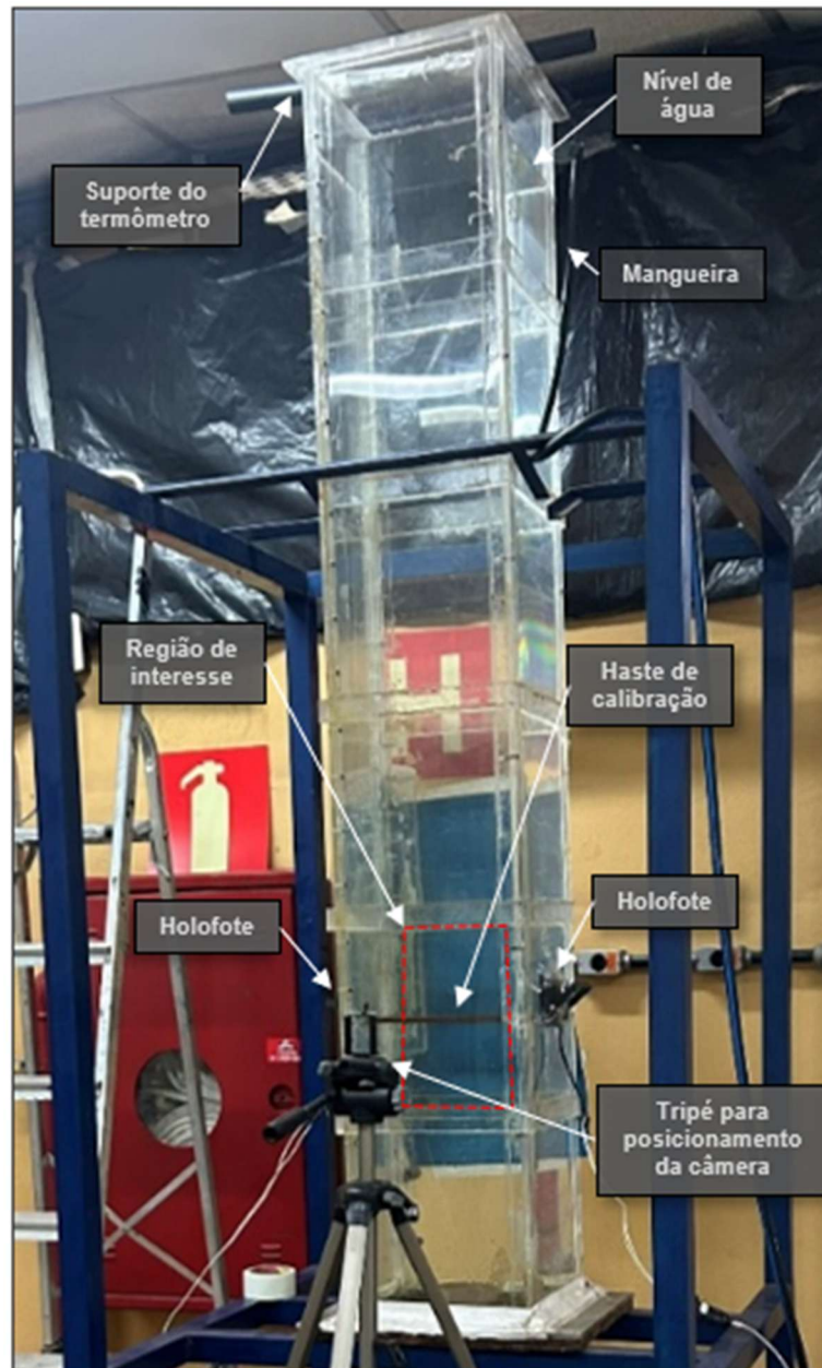
Figura 12 - Foto do aparato experimental utilizado para a determinação da velocidade de queda das partículas.
