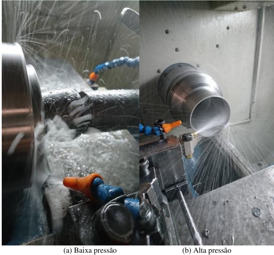
Figura 2: Dispositivo de lubri-refrigeração: (a) baixa pressão e (b) alta pressão.
