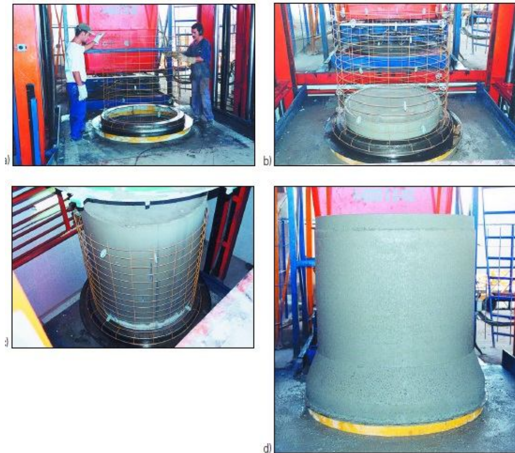
FIGURA 13 – Fabricação tubos circulares de concreto armado Fonte: ABCT, online, acesso em agosto de 2015
