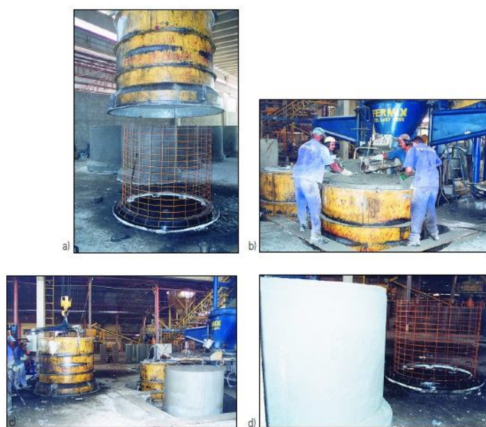
FIGURA 11 – Fabricação tubos circulares de concreto armado Fonte: ABCT, online, acesso em agosto de 2015
