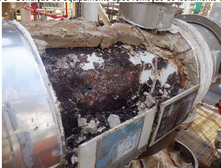
Figura 8 - Condição do equipamento após remoção do isolamento térmico.
