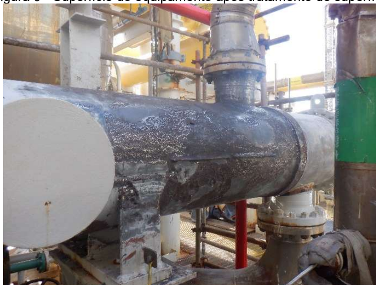
Figura 9 - Superfície do equipamento após tratamento de superfície
