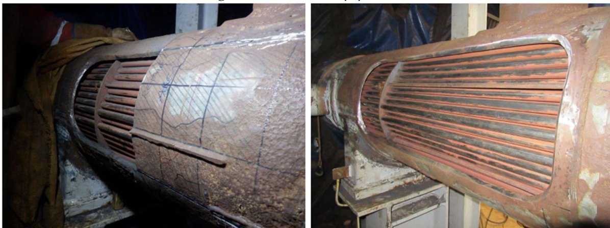
Figura 13 - Corte do equipamento
