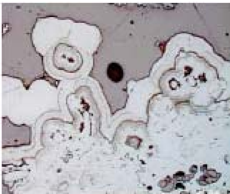
Figura 3.7.2 – Mineral de Ghoetita, baseado na Tabela dos principais tipos texturais de cristais de óxido/hidróxidos de ferro (Queiroz, 2003).
