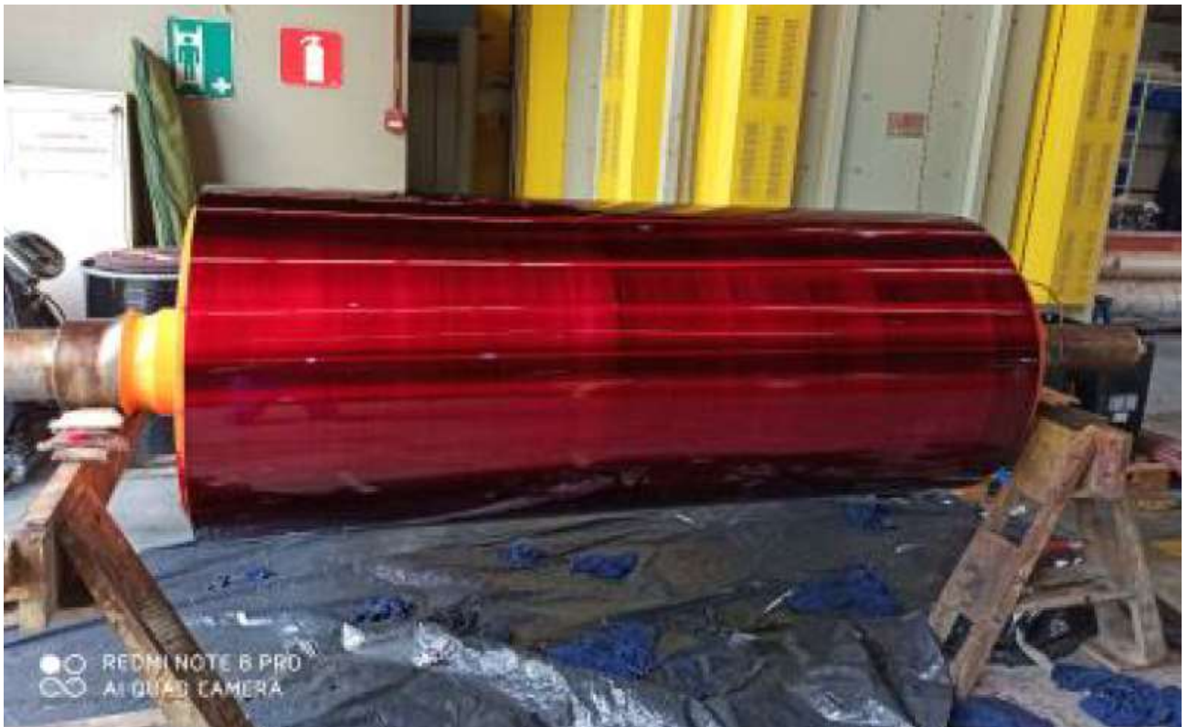
Figura 36 – Rolo com penetrante, pós usinagem e retífica final. Fonte: Autor
