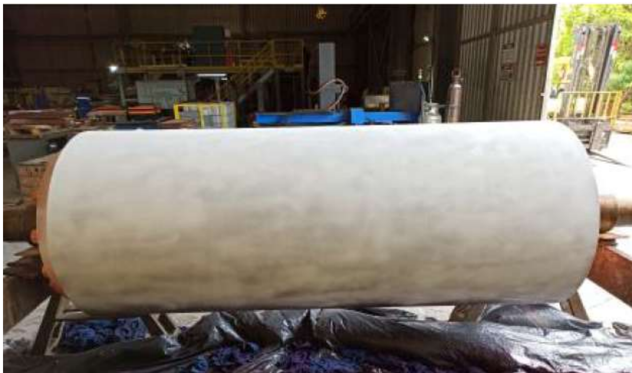
Figura 37 – Rolo com revelador, pós usinagem e retífica final. Fonte: Autor
