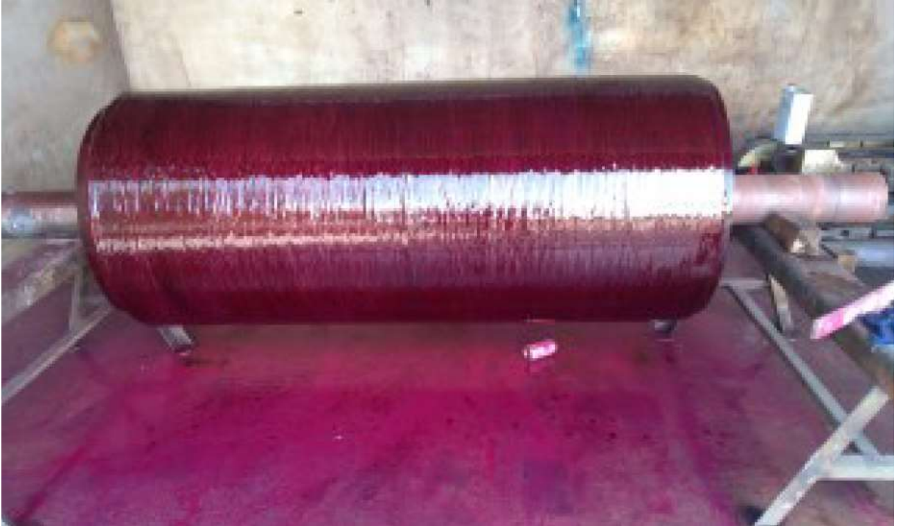
Figura 34 – Rolo com penetrante final, pós soldagem revestimento duro. Fonte: Autor
