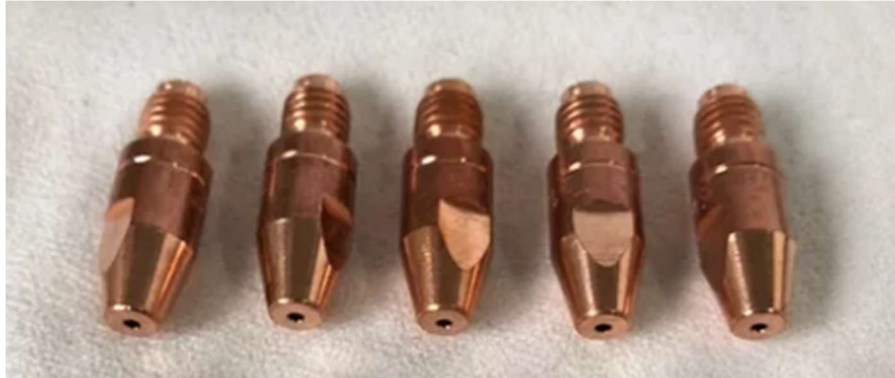
Figura 21 – Bicos de Contato CuCrZr. Fonte: Autor
