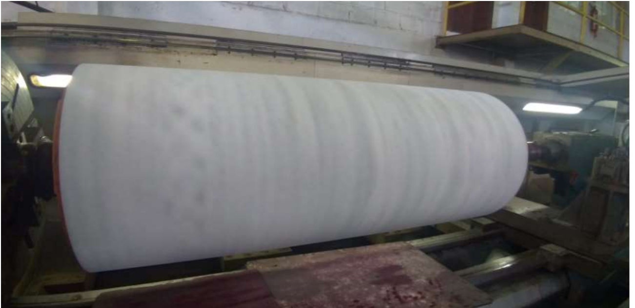
Figura 32 – Rolo com revelador após usinagem. Fonte: Autor
