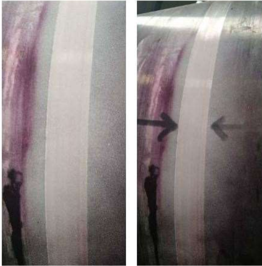
Figura 8 - Resultado LP antes usinagem final. Fonte: Autor
