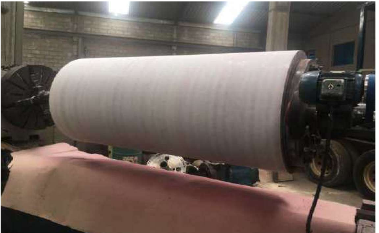
Figura 10 – Rolo com revelador após usinagem final. Fonte: Autor
