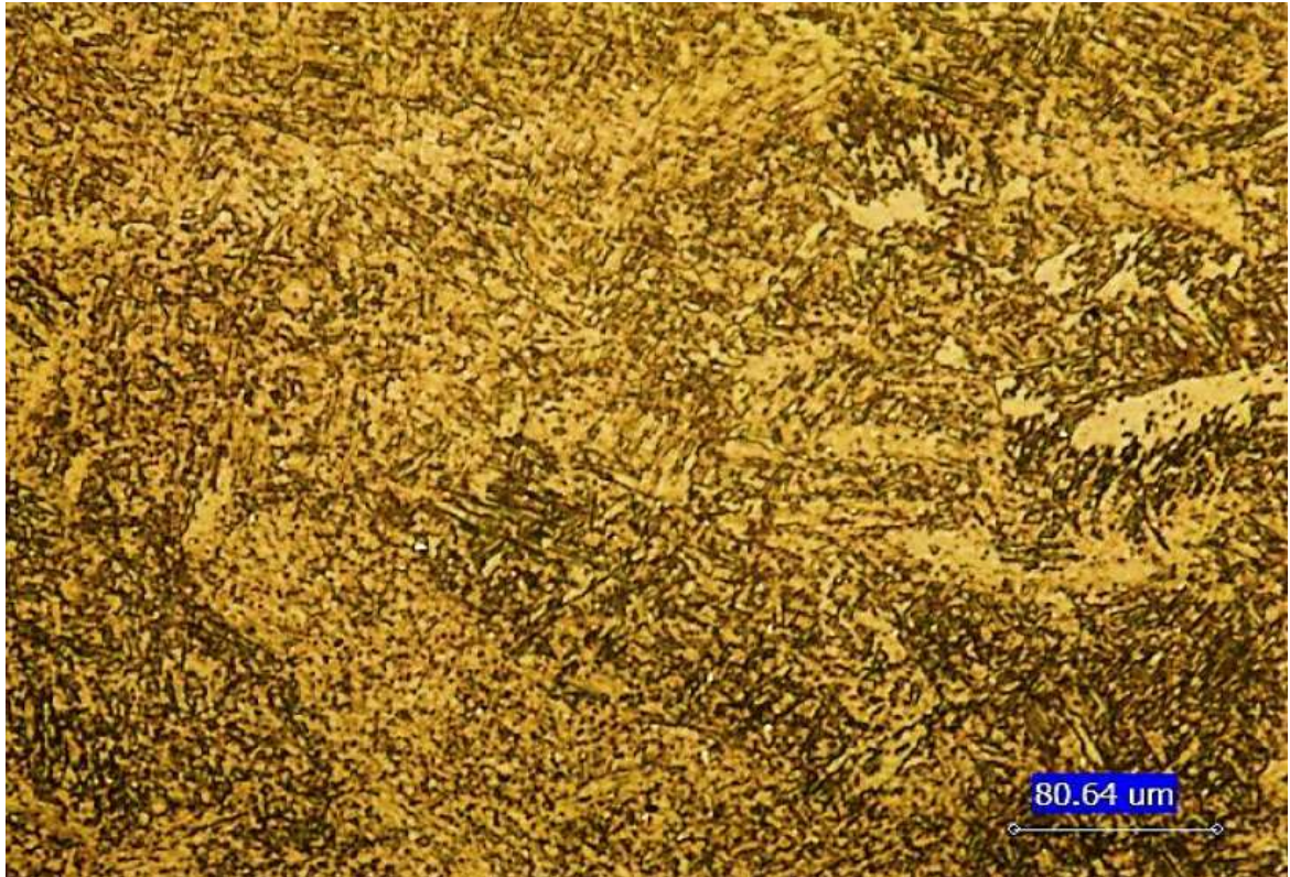
Figura 29 – Réplica Metalográfica – Aumento de 200X. Fonte: Autor
