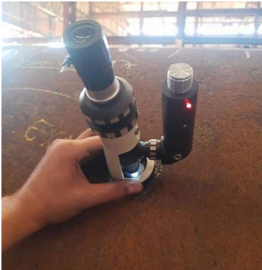
Figura 19 – Réplica metalográfica. Fonte: LPB Inspeções, 2024
