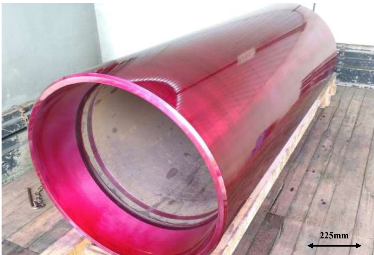
Figura 4 – Rolo com Líquido Penetrante aplicado. Fonte: Autor
