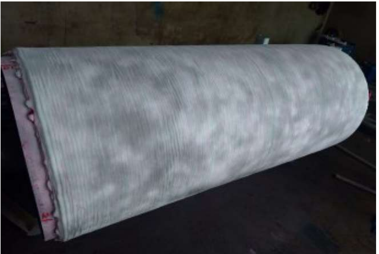
Figura 35 – Rolo com releve, final pós soldagem revestimento duro. Fonte: Autor
