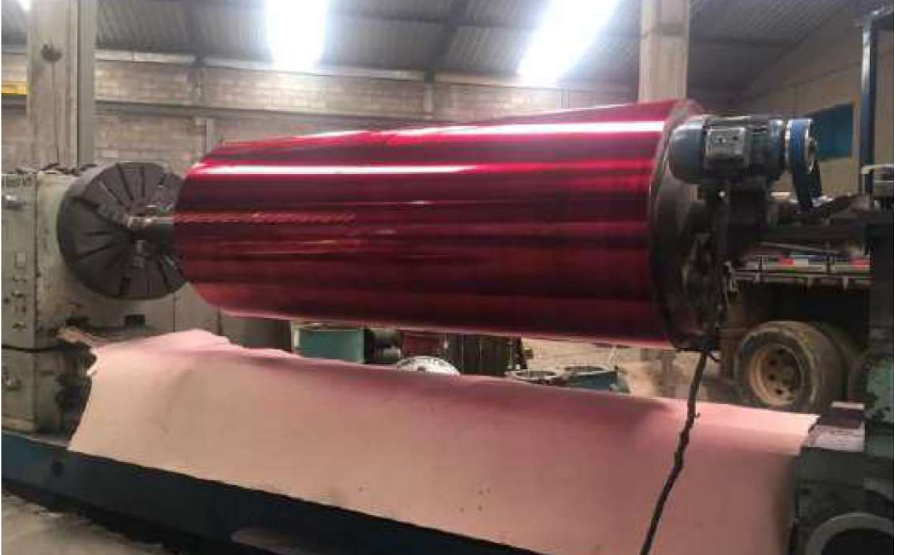
Figura 9 – Rolo com penetrante após usinagem final. Fonte: Autor
