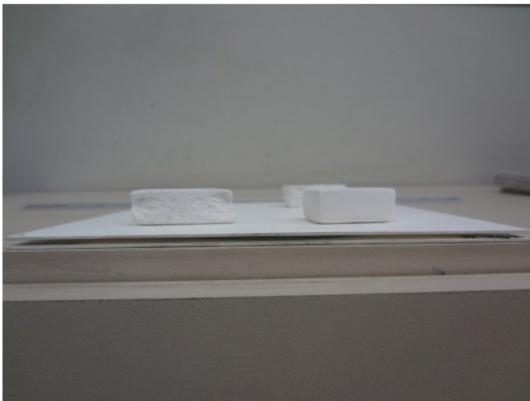
Figura 3.7 – Montagem do suporte de sinterização. Os discos de anodo são sinterizados a pressão de 345 Pa.
