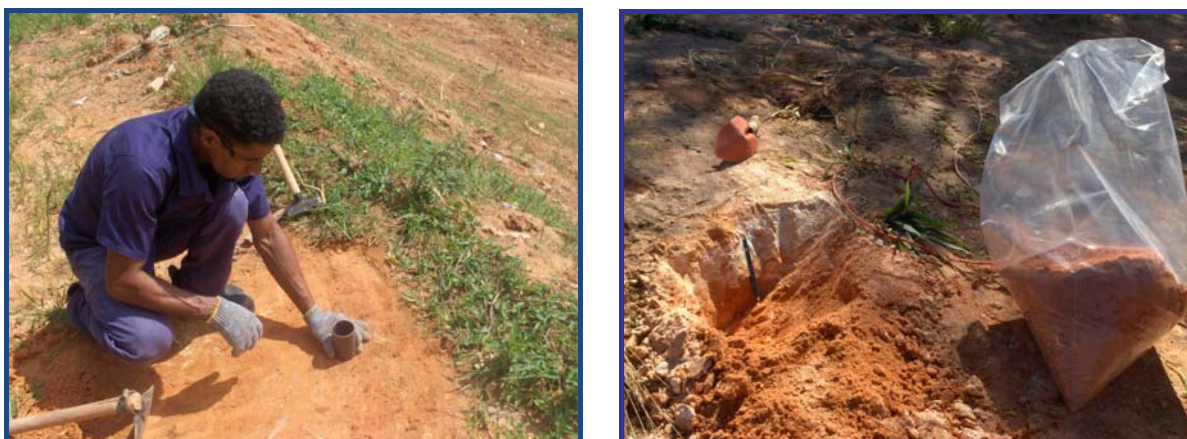
Figura 4.1 – Caracterização física (a) Massa específica e teor de umidade; (b) Coleta de amostras de solo para análise
