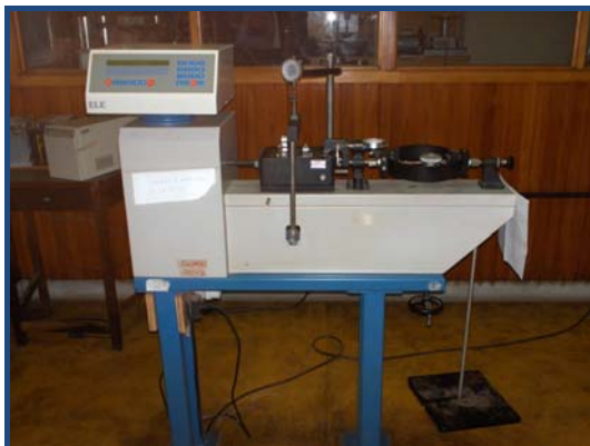
Figura 4.6 – Ensaios de cisalhamento direto: (a) Prensa de cisalhamento direto; (b) Corpo de prova após o ensaio
