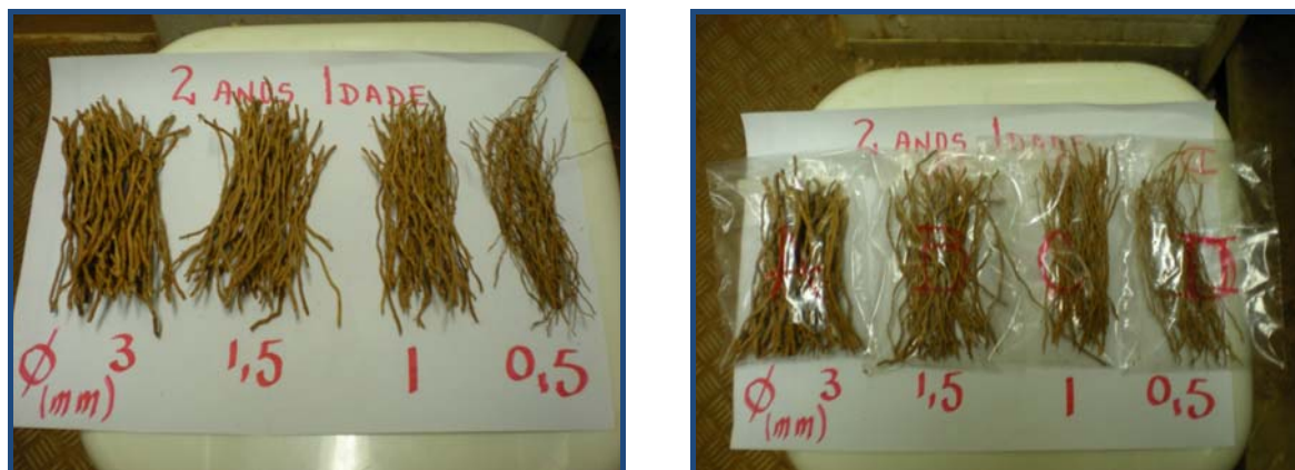
Figura 4.9 – Corpos de prova para ensaios de tração de raízes com diferentes diâmetros
