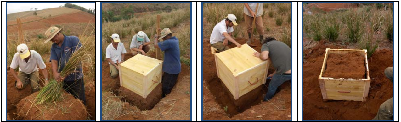
Figura 4.5 – Procedimento de coleta de amostras indeformadas em campo
