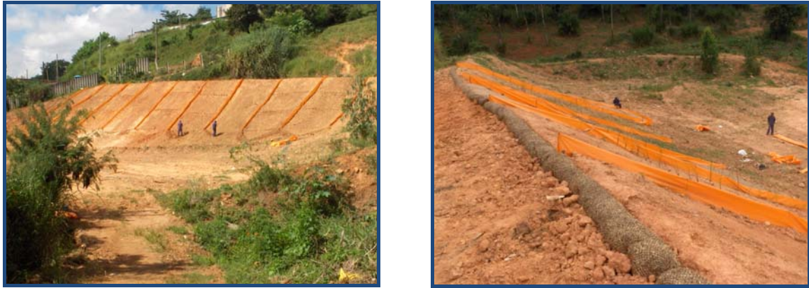
Figura 4.3 – Detalhes das parcelas: (a) Lâminas plásticas; (b) Retentor de sedimentos tipo Bermalonga©
