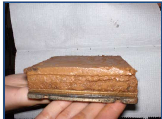
Figura 4.6 – Ensaios de cisalhamento direto: (a) Prensa de cisalhamento direto; (b) Corpo de prova após o ensaio
