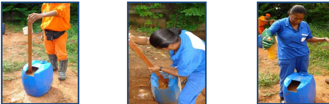
Figura 4.11 – Procedimento de coleta de amostras em campo para avaliação da perda de solo: (a) Medição da altura de água escoada; (b) Homogeneização da mistura; (c) Retirada de alíquota
