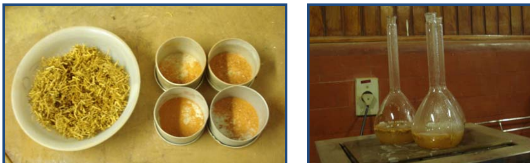
Figura 4.7 – Ensaio de raízes: (a) Cinza gerada após incineração de raízes; (b) Ensaio de massa específica das raízes
