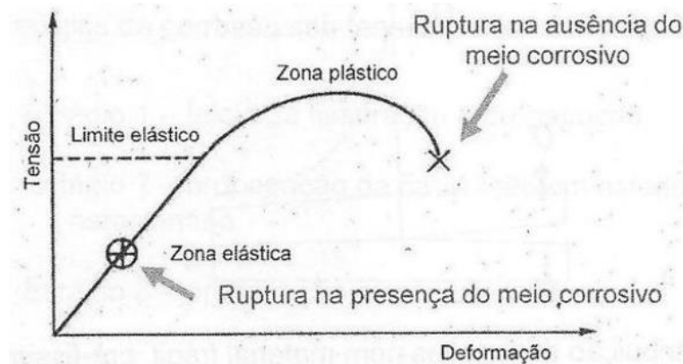
Figura 9: Curva de tensão deformação típica de um aço dúctil indicando o domínio das tensões elásticas da CST (COSTA, 2010).
