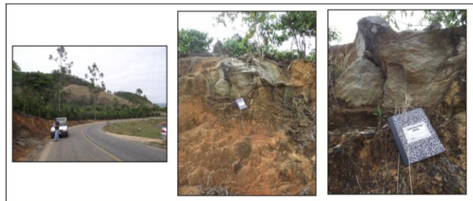
Figura 3.30: Blocos rolados de rocha leucocrática tardia em meio a um regolito alaranjado e arenoso (possivelmente produto intempérico originado a partir deste litotipo): visão panorâmica e detalhada do afloramento (Ponto 1).
