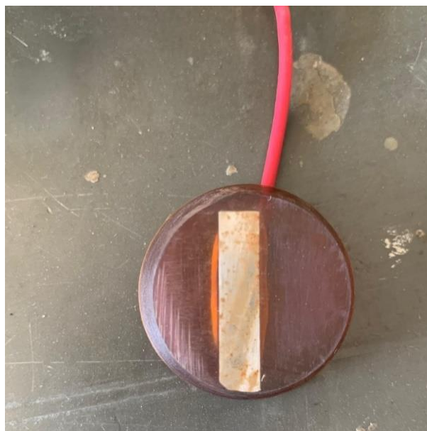
Figura 3. 1 – Foto de uma das amostras após a realização do ensaio de polarização, apresentando o embutimento e fio para contato elétrico.
