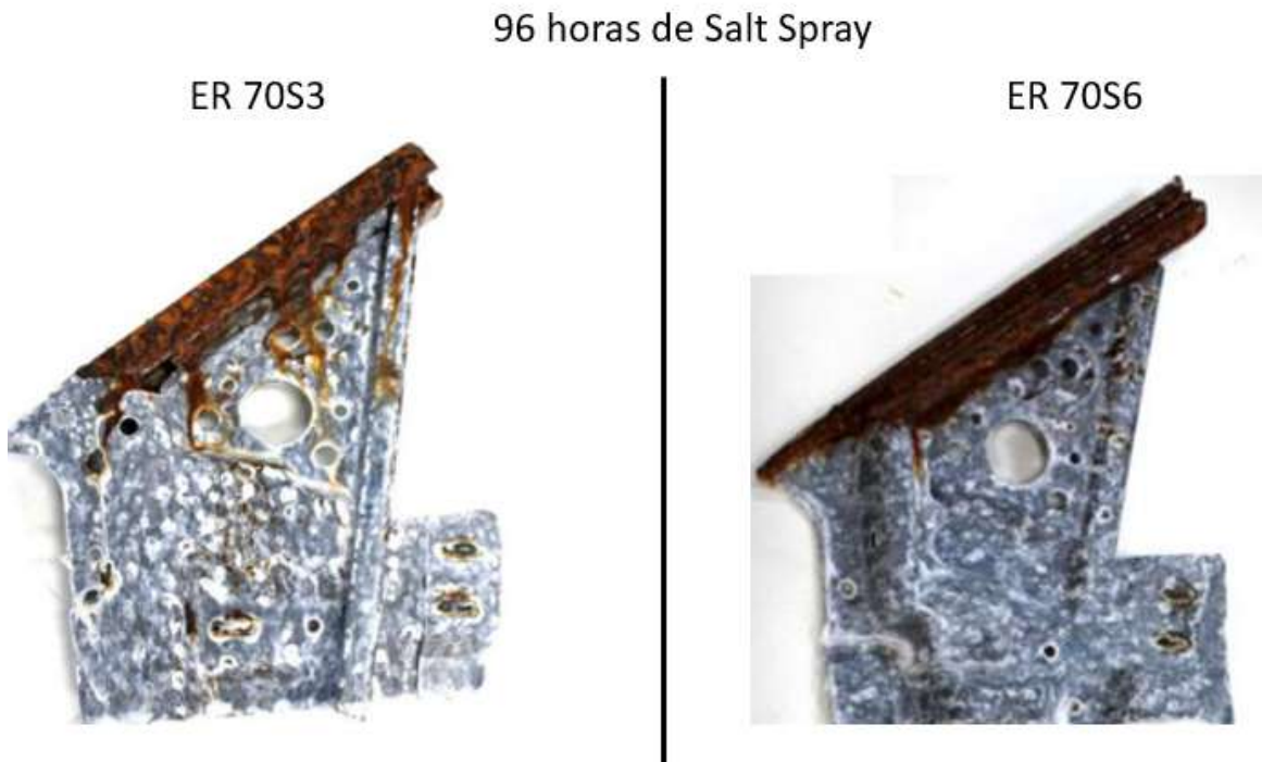
Figura 36: Resultados obtidos após 96 horas de Salt Spray. Aqui, o corpo de prova soldado com ER70S-3 começou a apresentar pontos de oxidação vermelhos (metal base) na área de ZTA dos cordões de solda.
