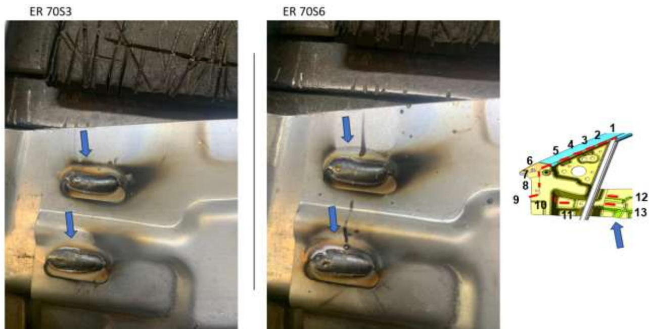
Figura 31: Filetes de número 12 e 13. Nota-se uma maior queima da área galvanizada no componente soldado com ER70S6.
