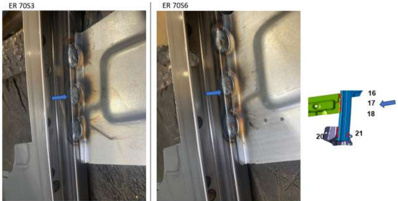
Figura 29: Filetes de número 16, 17 e 18. Presença de Porosidade no cordão 17 feito com o arame ER70S6.
