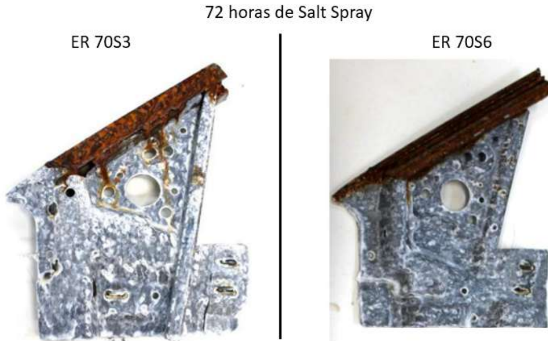
Figura 35: Resultados obtidos após 72 horas de Salt Spray, onde houve corrosão de zinco (branca) e corrosão do metal base (vermelha) Aqui, o corpo de prova soldado com ER70S-6 começou a apresentar pontos de oxidação vermelhos (metal base) na área de ZTA dos cordões de solda.
