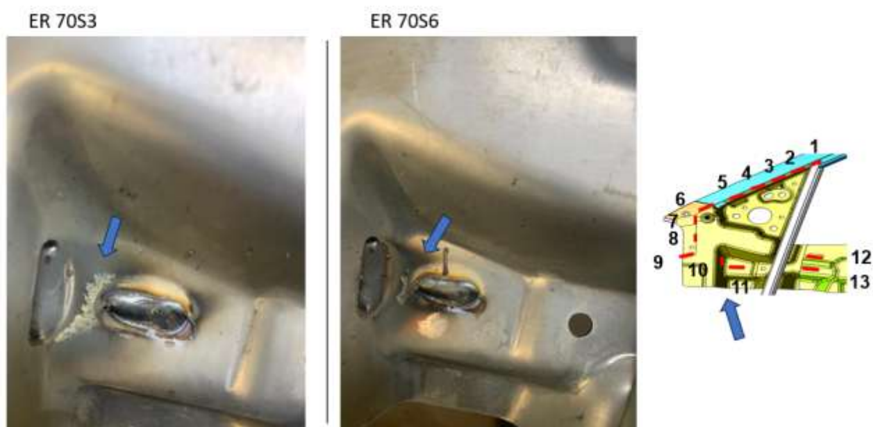
Figura 32: Filetes de número 10 e 11. Nota-se uma maior queima da área galvanizada no componente soldado com ER70S6.
