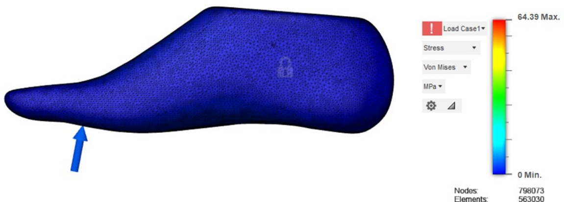
Figura 77: Tensão máxima e localização no modelo na impulsão em ABS
