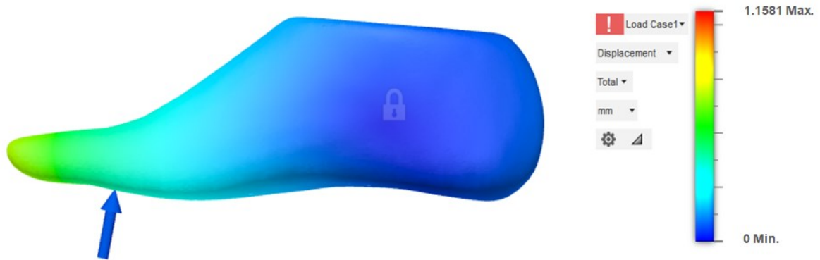
Figura 80: Deslocamento máximo e localização no modelo na impulsão em PETG
