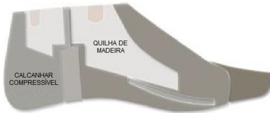
Figura 6: Ilustração de uma seção do pé SACH
