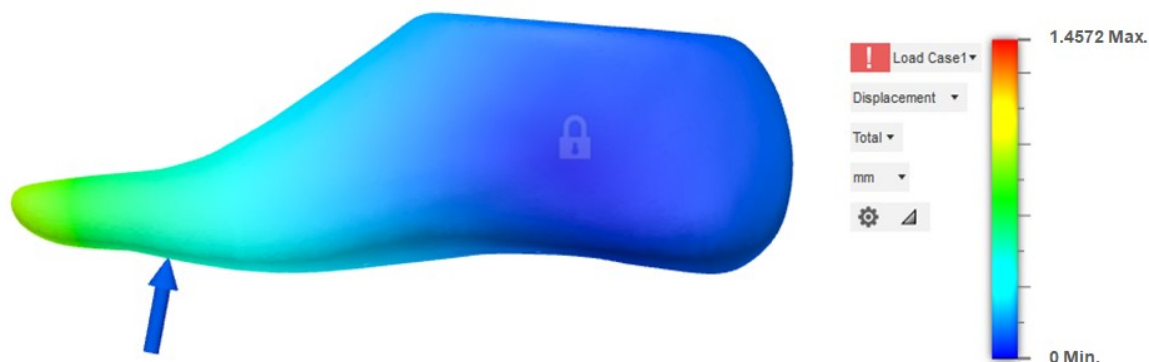
Figura 78: Deslocamento máximo e localização no modelo na impulsão em ABS
