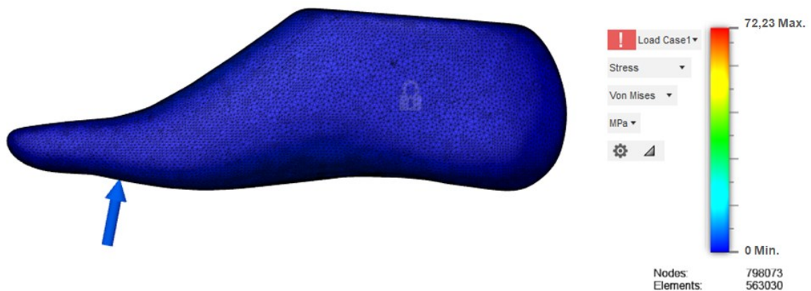
Figura 81: Tensão máxima e localização no modelo na impulsão em PLA
