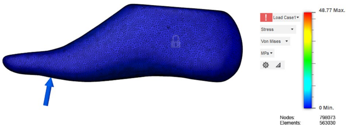
Figura 79: Tensão máxima e localização no modelo na impulsão em PETG
