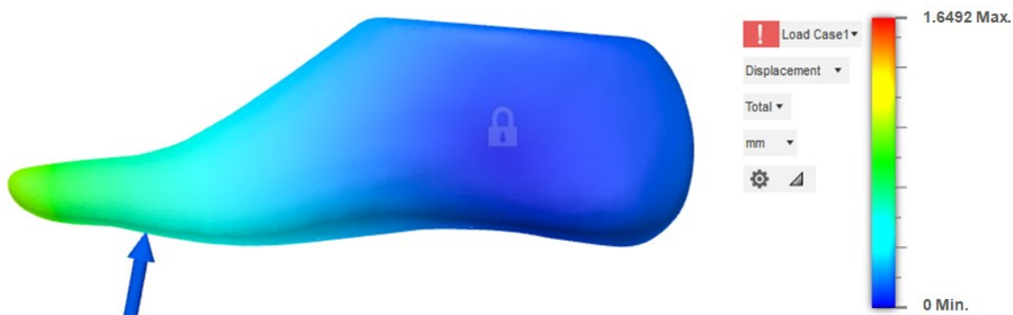
Figura 82: Deslocamento máximo e localização no modelo na impulsão em PLA
