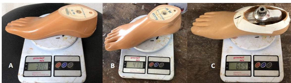
Figura 87: Pesos pés SUS: (a) pé SACH , (b) pé de adaptação dinâmica e (c) pé articulado
