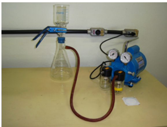
Figura 21: Sistema de filtragem
