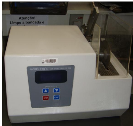
Figura 4.7 – Equipamento utilizado para corte
