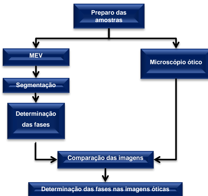
Figura 4.10 – Modelo esquemático da análise de imagens obtidas no microscópio ótico
