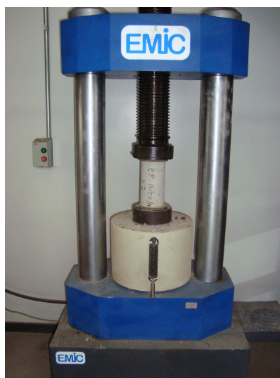
Figura 4.24: Ensaio de Compressão Uniaxial
