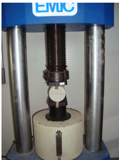
Figura 4.30: Ensaio de Compressão Diametral
