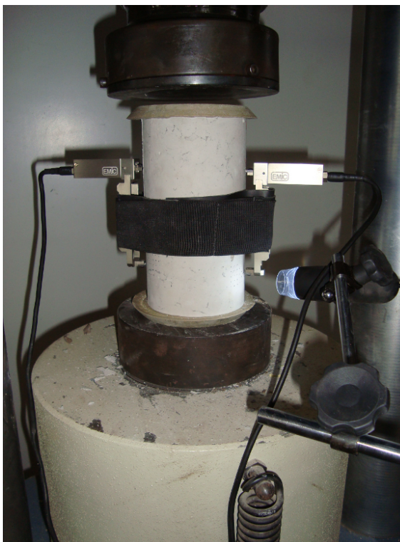
Figura 4.27: Configuração real do experimento usando a máquina servo-hidráulica EMIC, Modelo PC 200 e o microscópio USB 800x. O exemplar também está com o Clip Gauge afixado.
