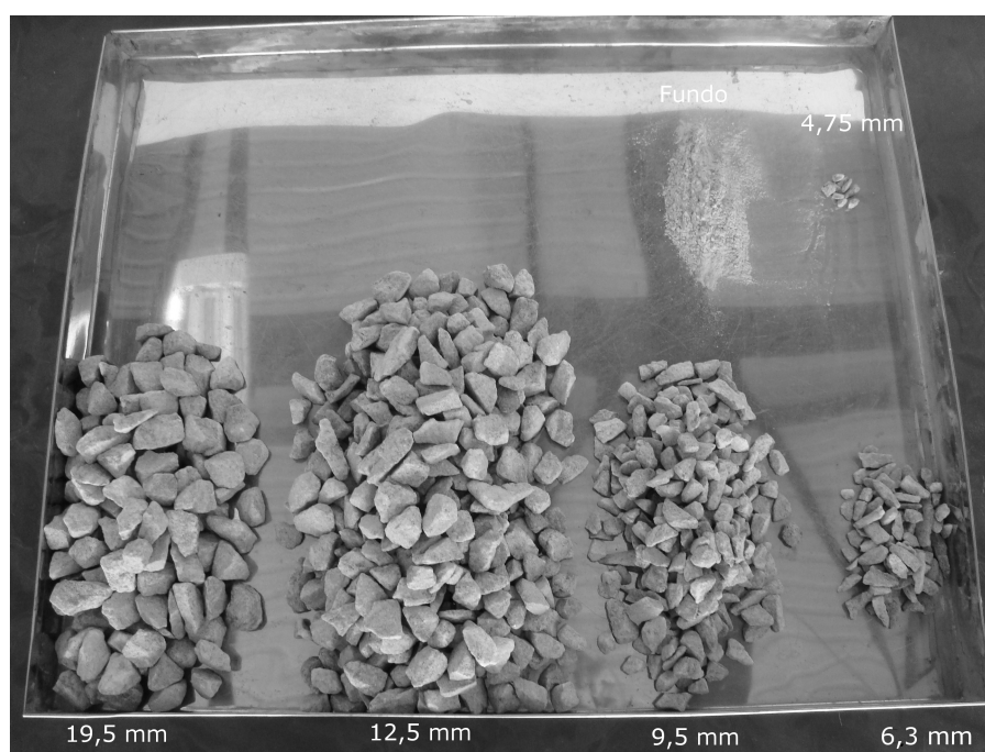
Figura 4.2: Distribuição Granulométrica - Agregado Graúdo - \phi_{max} = 25,0 mm
