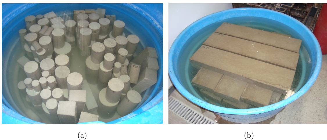
Figura 4.15: Cura dos Corpos de Prova
