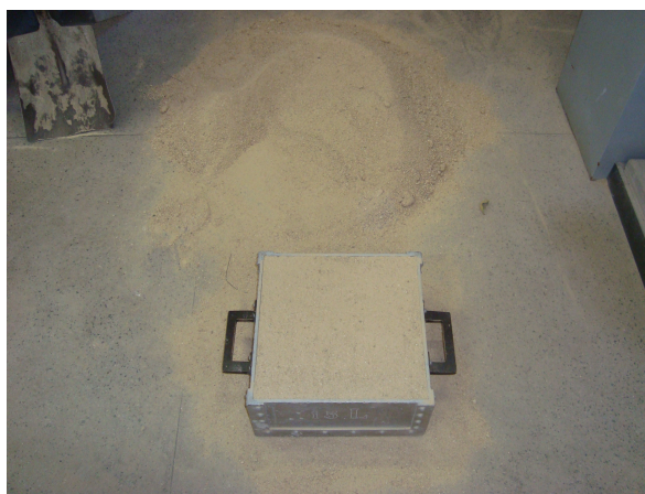
Figura 4.10: Massa Específica - NBR NM 52 (2009)
