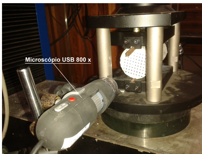
Figura 4.31: Uso do DIC para o ensaio de compressão diametral
