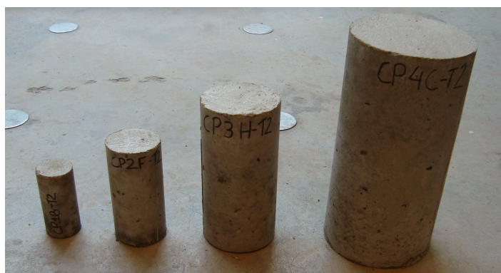
Figura 4.21: Proporção entre os Corpos de prova cilíndrico
