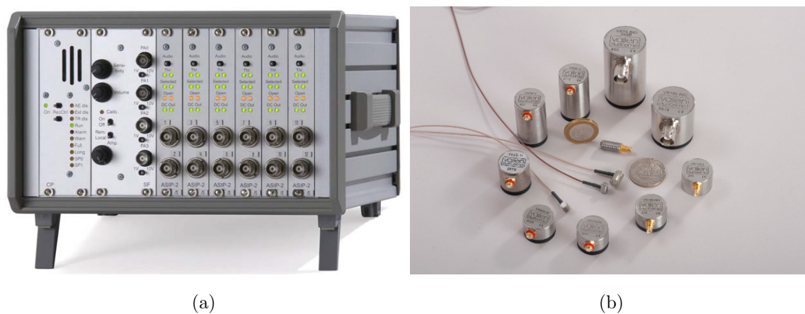
Figura 4.38: Equipamentos da Emissão Acústica
