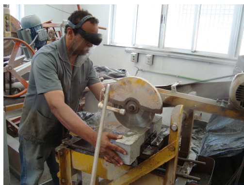
(b) Execução do entalhe nas vigas
