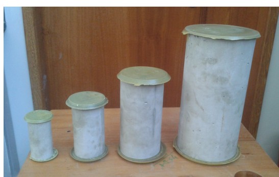
(a) Capeamento dos corpos de prova
