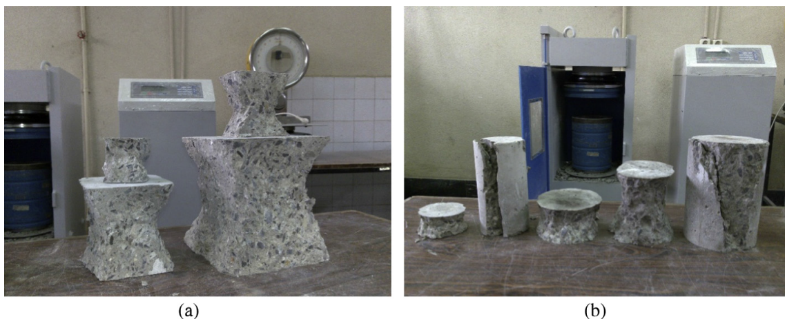
Figura 2.8: Corpos de prova utilizados por Dehestani et al. (2014): (a)cubos e (b) cilindros
