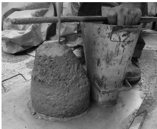
Figura 4.13: Abatimento do Tronco de Cone
