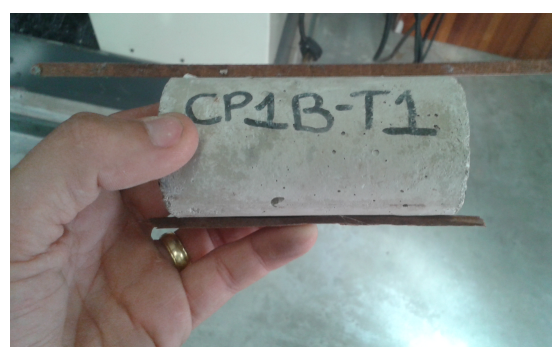
(b) Ripas acopladas nos Corpos de Prova
