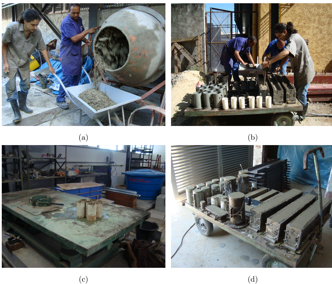
Figura 4.14: Concretagem e vibração dos corpo de prova: (a) Retirada do concreto; (b) Vibração Mecânica das Vigas; (c) Mesa Vibratória; (d) Corpos de prova concretados
