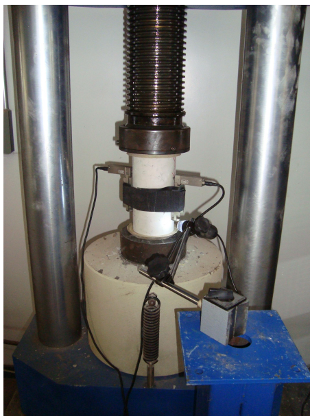
Figura 4.25: Ensaio de Módulo de Elasticidade
