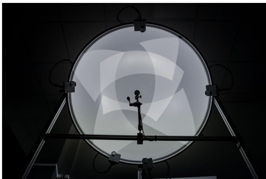
Figura 14 - Sistema de calibração de projeção multicanal com visão computacional
