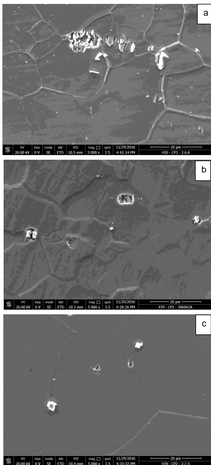
Figura 5-77: Superfícies após polimento e ataque químico com ácidos mistos. Foto “a” aço 430. Foto “b”, aço 439 de granulação fina. Foto “c”, aço 439 com grãos grossos..
