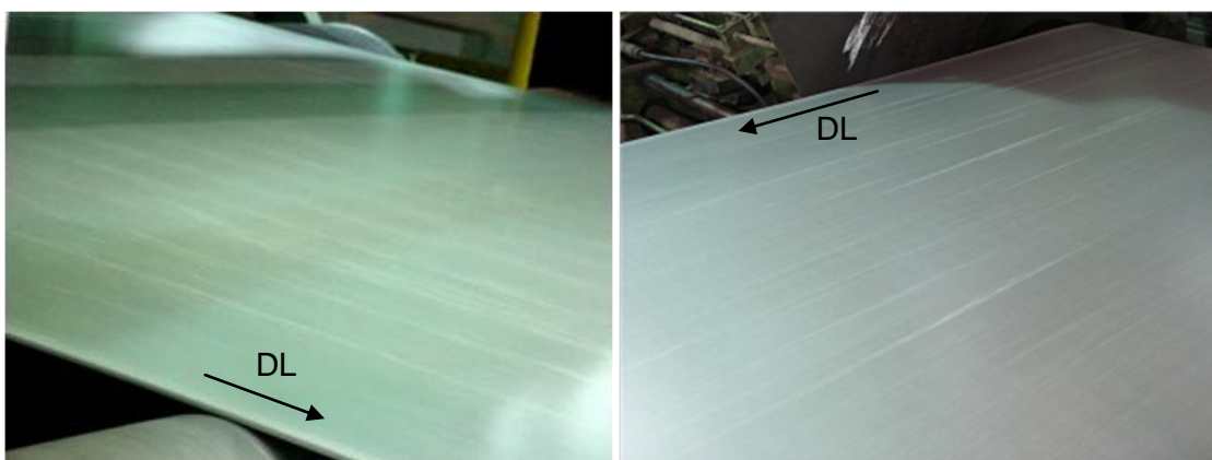
Figura 5-1: Faixas em forte impacto visual após a decapagem química mista ( \text{HNO}_3 e \text{HF} ) e aspecto visual poroso. Na foto a esquerda é mostrada a superfície heterogênea numa bobina laminada a quente e, à direita, noutra bobina laminada a frio e recozida, sendo ambas na largura 1240mm.
