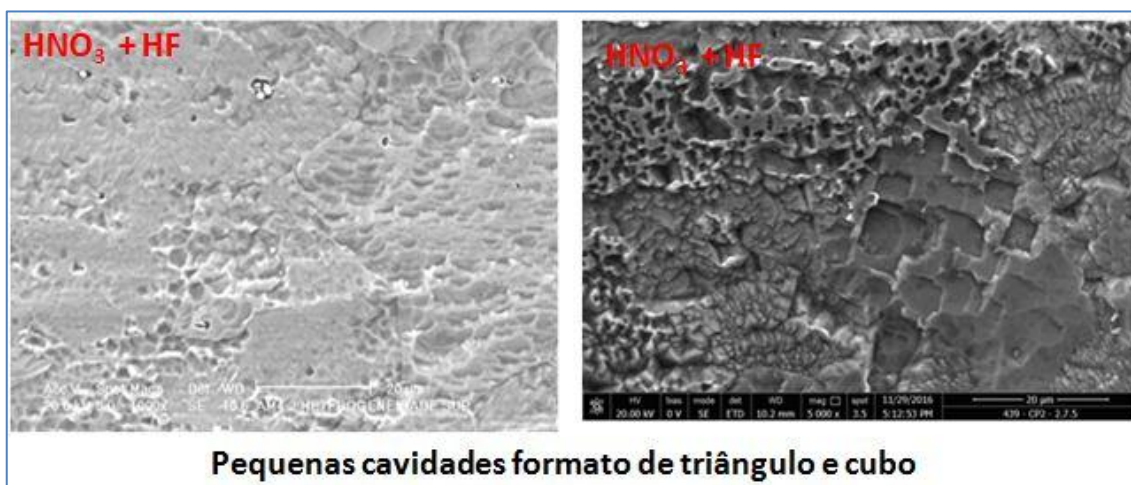
Figura 5-114: Cavidades provocadas pelo ataque localizado na superfície (“etch pits”).
