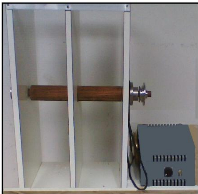
Figura 8 - Fotografia do equipamento Rotarod utilizado para a avaliação do equilíbrio e coordenação motora dos animais.
