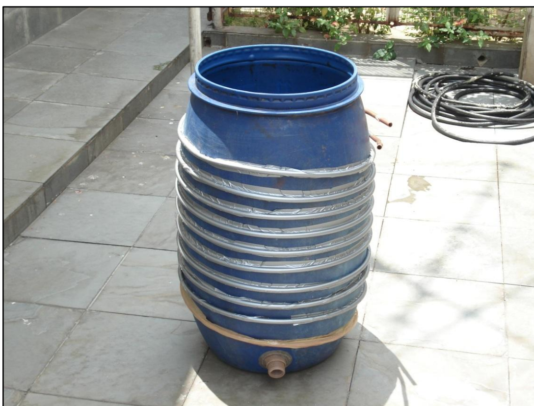
Figura 4.3 – Serpentinhas de cobre instaladas no reator de metanogênese
