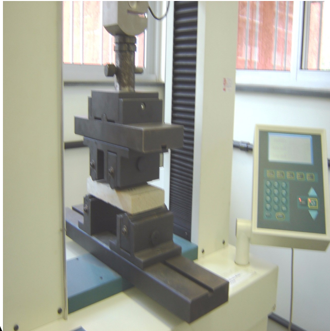
Figura VI.2: Prensa hidráulica da marca TINIUS OLSEN, modelo H 25K-S para ensaios de resistência à flexão 4 pontos (A), e esquema de posicionamento dos cutelos (B), Laboratório de Caracterização Tecnológica de Rochas Ornamentais /CPMTC.
