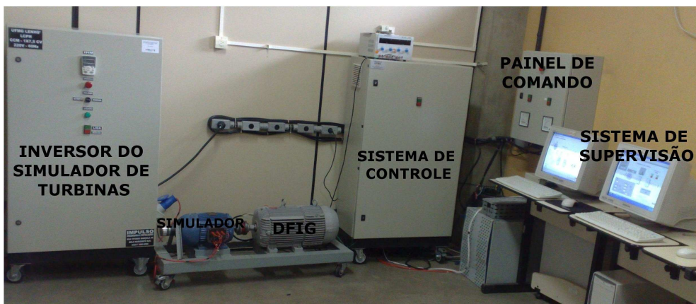
Figura 2.19: Fotografia da bancada experimental.
