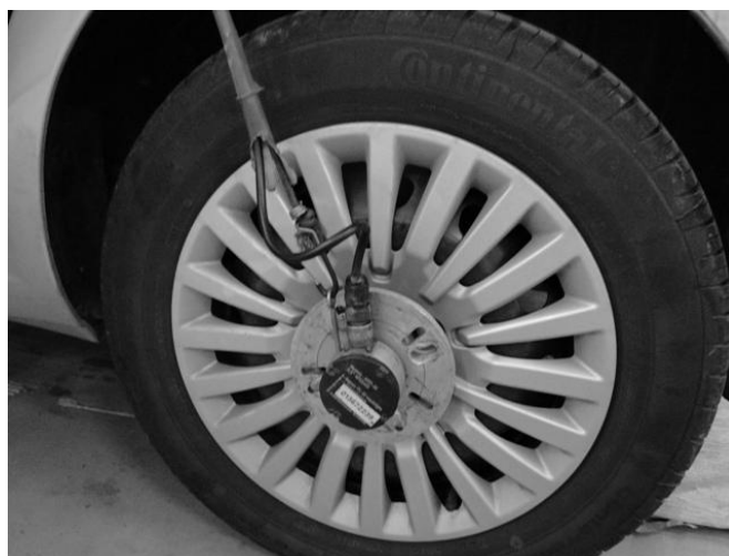
FIGURA 5.12 – Posição da rodafônica (leitura de velocidade)
