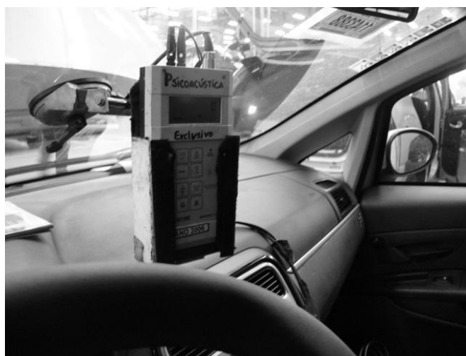
FIGURA 5.13 – Posição do tacômetro (leitura de rotação)
