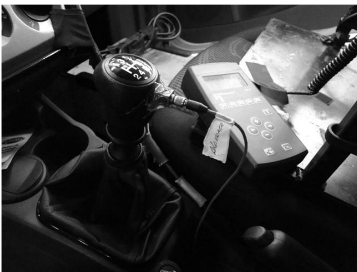
FIGURA 5.11 – Posição do sensor de vibração na alavanca de câmbio (ponto 5)
