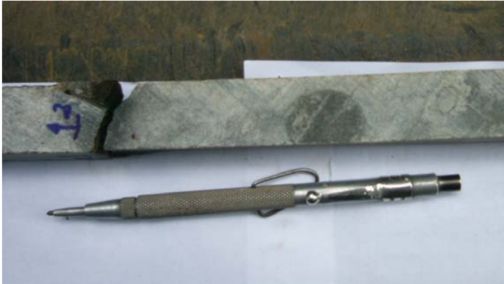
Figura 20: Alvo Taperebá D - FD 196-42, bi-gru-di carbonato silicática, cinza, levemente foliada.
