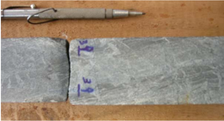
Figura 19: Alvo Taperebá B - FD 703-23237, gru-di-mt carbonato silicática, cinza, localmente fraturada.
