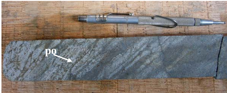
Figura 18: Alvo Taperebá C - FD 162-192, serp-po-mt carbonato silicática com porções bandadas e porções isotrópicas, contendo po disseminadas ou em lâminas.
