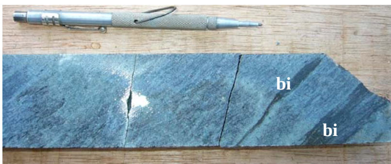
Figura 21: Alvo Taperebá D - FD 640-10210, bi-gru-di carbonato silicática, cinza, levemente foliada, com lâminas e bandas de biotita.
