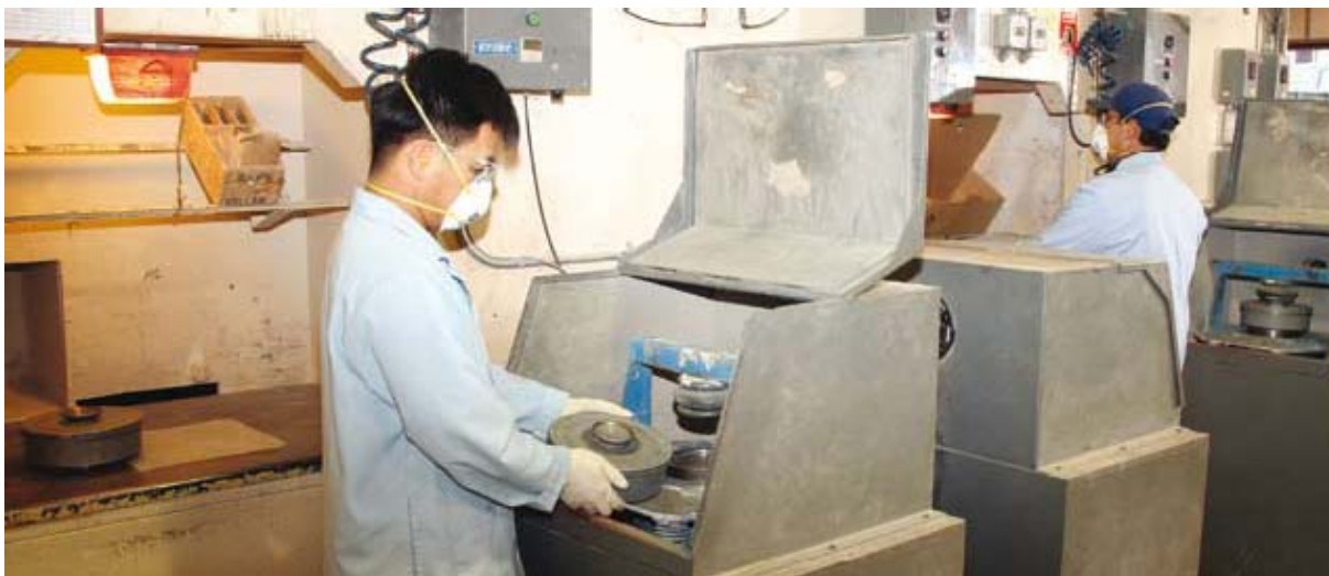
Figura 39: Pulverizador de disco de aço-cromo (Fonte - catálogo do Laboratório ALS Chemex, 2005).
