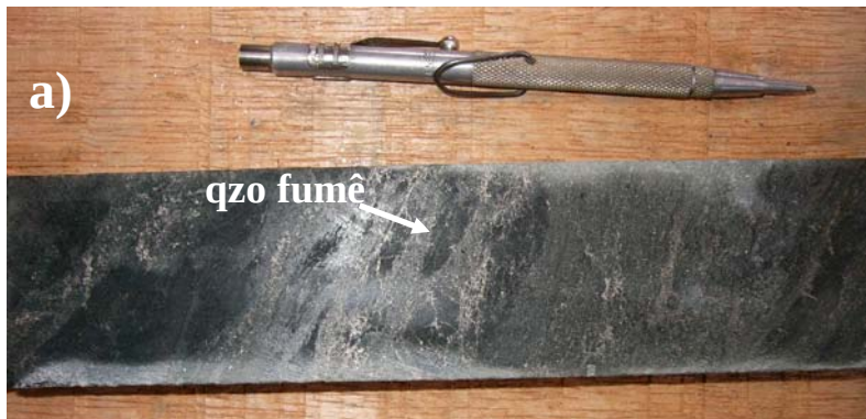
Figura 12: Alvo Urucum, FD 795-57438, gru-po-hbl FFb, a) e b) Bandas de quartzo englobando massas de quartzo (qzo) fumê, concordantes com o bandamento. b) Pirrotita (po) disseminada, ou formando lâminas junto a bandas ricas em anfibólio.
