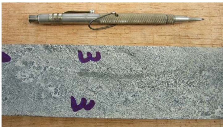
Figura 17: Alvo Taperebá A - FD 659-18621, mgcl-mt-serp carbonato silicática. Pintas pretas são de mt.
