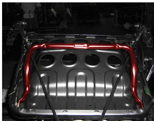
Figura 5 – Tubo final soldado a estrutura metálica pronta para ser embalada
