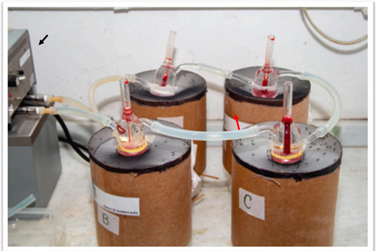
Figura 6: Sistema artificial de vidro utilizado para repasto sanguíneo de fêmeas de Aedes aegypti equipado com termocirculador (seta preta), com membrana acoplada a abertura inferior da estrutura de vidro do aparato (seta vermelha). Fonte: Dias et al. 2020
