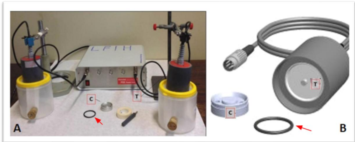
Figura 7: (A) Aparato Hemotek montado para a alimentação artificial de L. longipalpis ajustado em cima do pote telado onde os insetos são mantidos durante o repasto. (B) Detalhe do reservatório (c), do anel de vedação (seta vermelha) e do suporte termostatizado (t), onde o reservatório é acoplado, formando a unidade de alimentação. O aparelho permite a utilização em simultâneo de até cinco unidades de alimentação. O volume de sangue utilizado para uma refeição padrão de flebotomíneos é de 2ml. Foto: (A) Mauricio Sant'Anna (B) Manual do equipamento (Hemotek Ltd).
