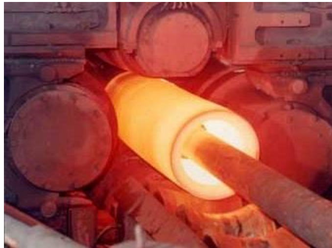
Figura 1.6. Processo de laminagem por perfuração.
