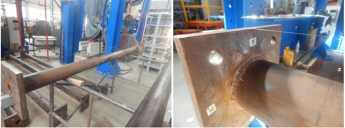
(a) Linha de nylon previamente tracionada posicionada no modelo. (b) Linha de nylon fixa na placa de base do modelo.
