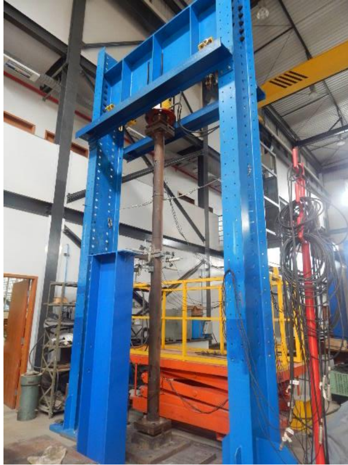
Figura 4.20. Pórtico utilizado para execução dos ensaios.
