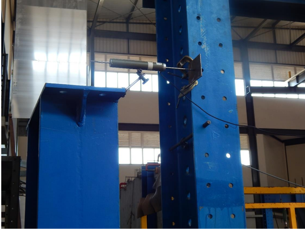
Figura 4.32. DT posicionado no pilar do pórtico.
