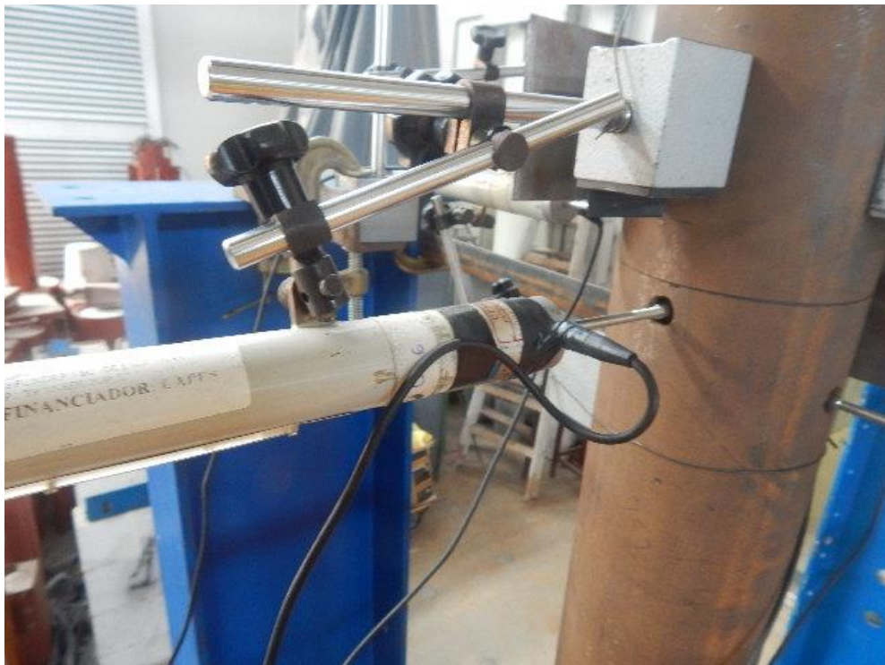
Figura 4.27. DT posicionado no tubo interno.
