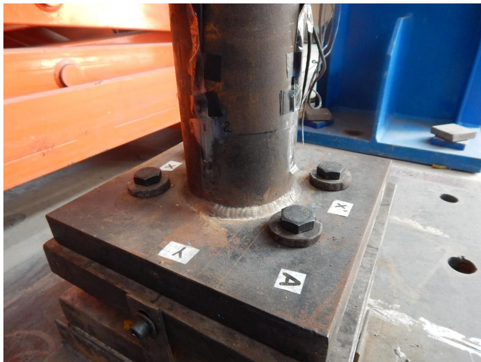
Figura 4.25. Base do modelo fixada à rótula semiesférica.
