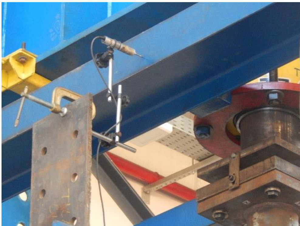
Figura 4.31. DT posicionado na viga de apoio do pórtico.
