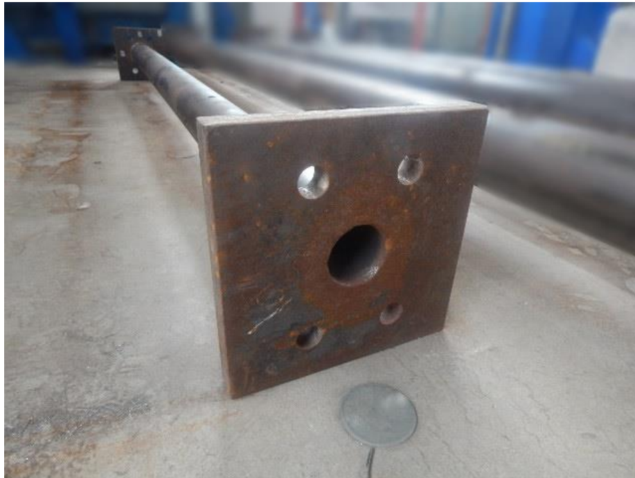
Figura 1.10. Perfil tubular circular composto concêntrico com flanges nas extremidades
