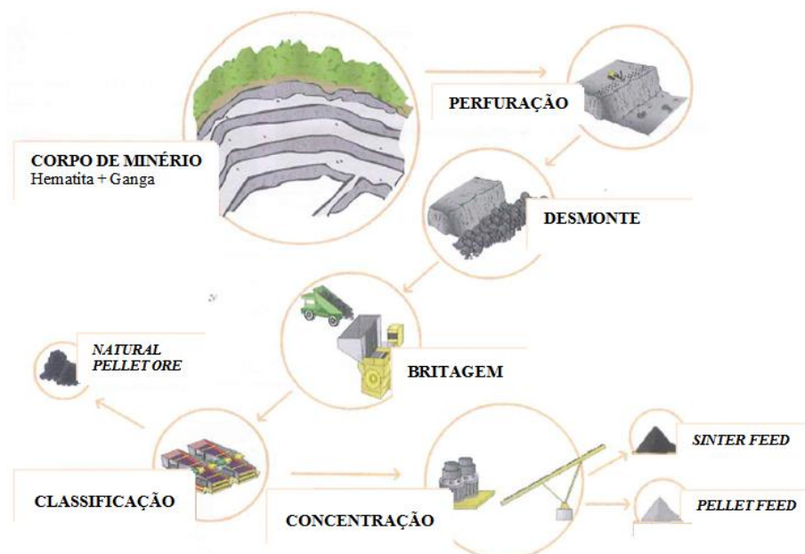
Figura 6 – Processo básico de extração e beneficiamento do minério de ferro.
