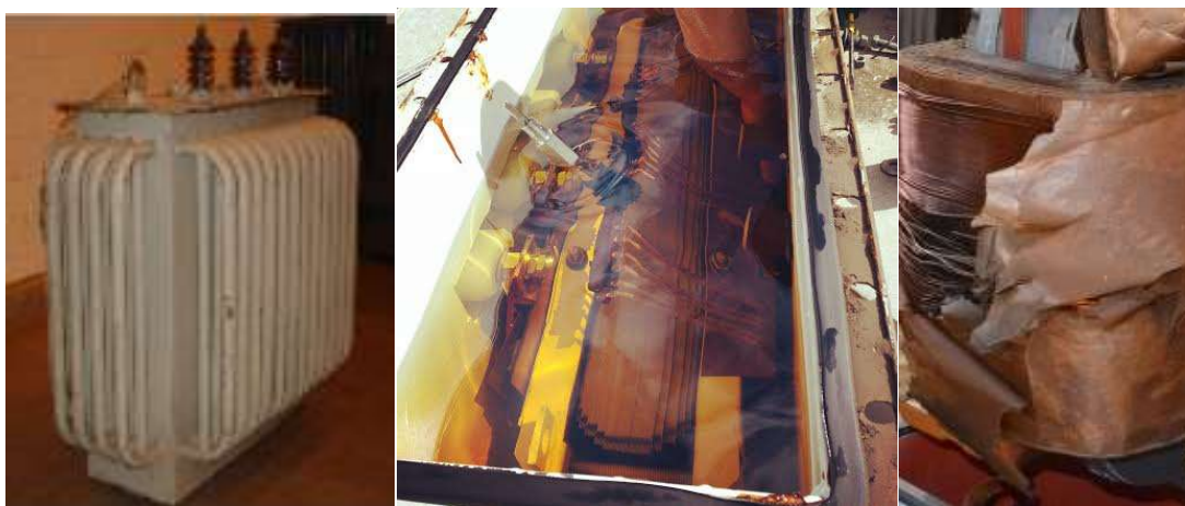
Figura 9: Composição básica de transformadores elétricos: A) carcaça metálica e isoladores cerâmicos (impermeáveis); B) fluido isolante; C) Parte ativa do núcleo composta de bobinas de cobre e lâminas de ferro silício (impermeáveis) e papel e madeira (permeáveis).
