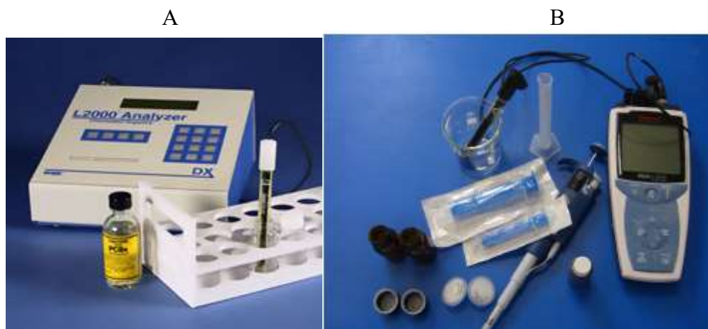
Figura 14: Fotos dos analisadores de nível de PCB pelo método do eletrodo seletivo de cloro das empresas Dexsil Corporation (A) e Sea Marconi Technologies (B).
