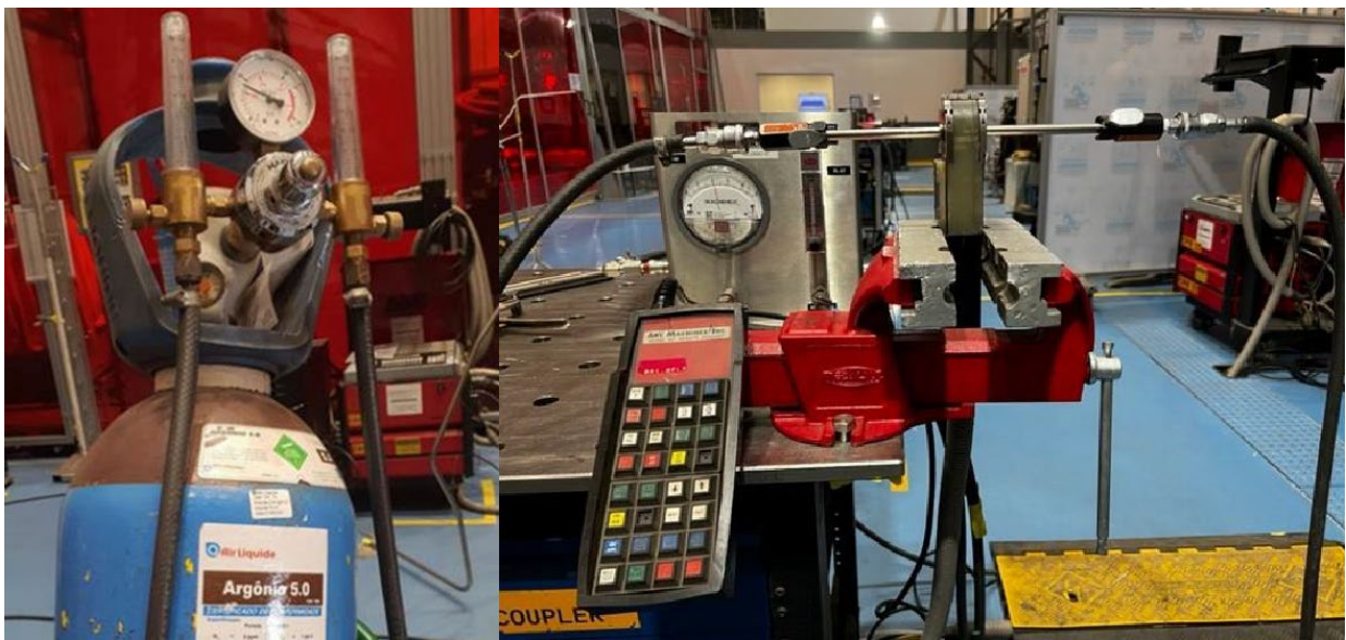
Figura 15: Sistema de purga associado ao manômetro diferencial
