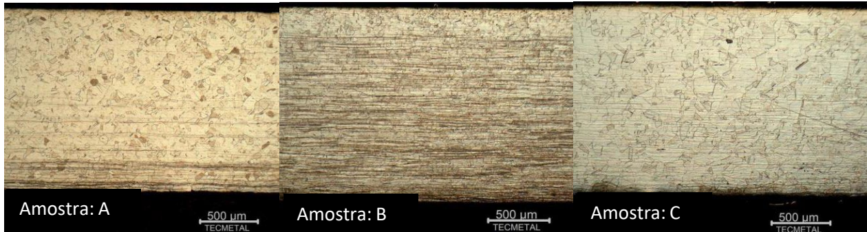
Figura 33: Aspecto micrográfico dos tubos A, B e C.
