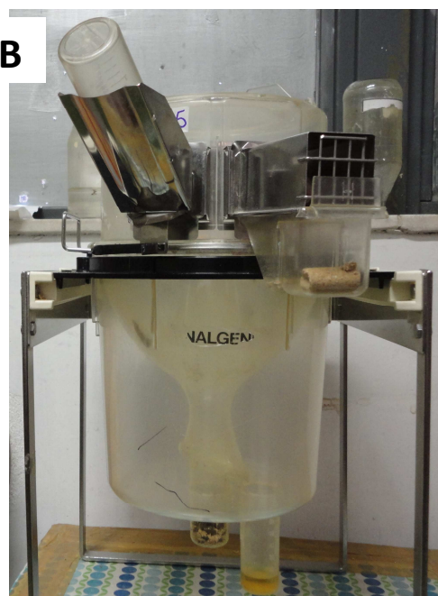
Figura 3 – Representação esquemática da gaiola metabólica na qual é possível monitorar a ingestão de água e ração, volume urinário e produção de fezes ( A ). B , vista frontal da gaiola metabólica utilizada nesse estudo. Os ratos foram mantidos, individualmente, em tais gaiolas desde a adaptação até o final do estudo.
