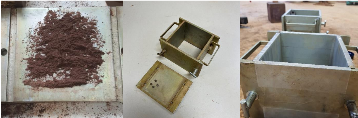
Figura 19 – Aderência da mistura à fôrma (esq.), montagem da fôrma (centro) e plastificação da fôrma (dir.).
