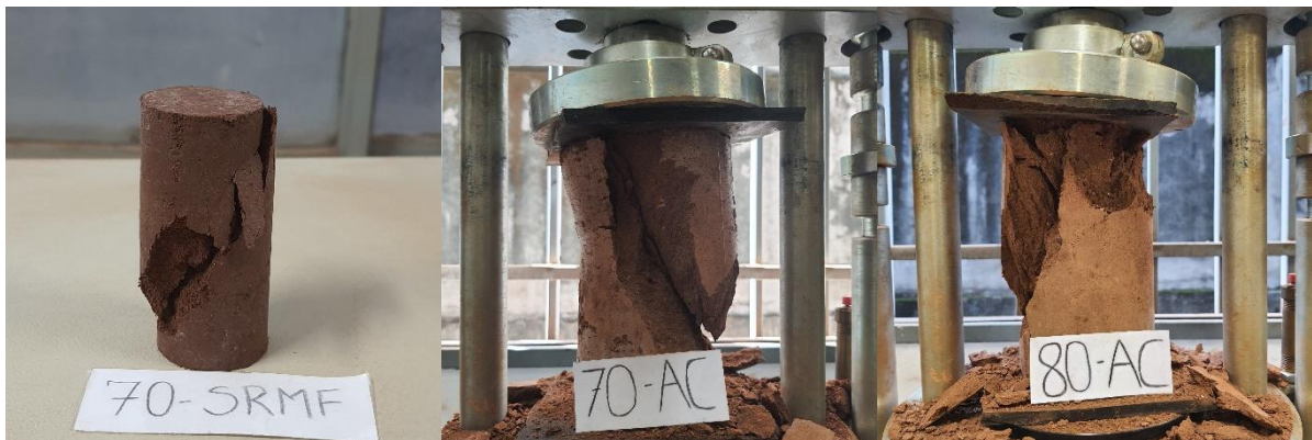
Figura 30 - Corpos de prova com ruptura diagonal.
