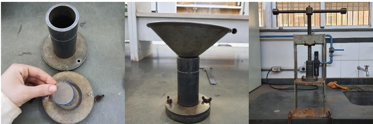
Figura 21 - Plástico no fundo da fôrma (esq.), fôrma montada com funil (centro) e equipamento para moldagem estática.
