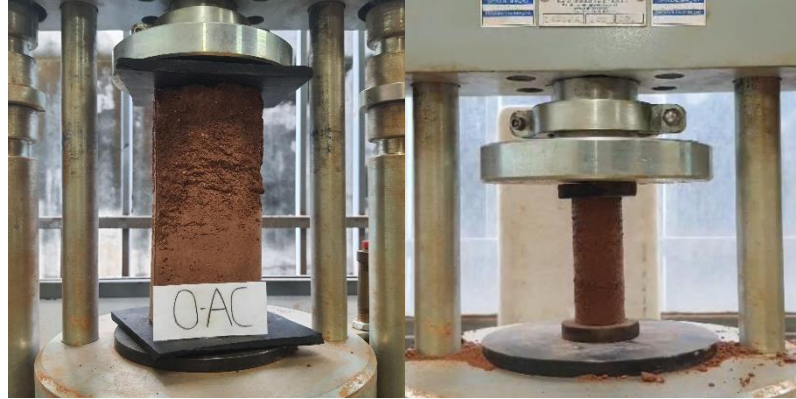
Figura 25 - Neoprene no corpo de prova na energia modificada (esq.) e energia normal (dir.).
