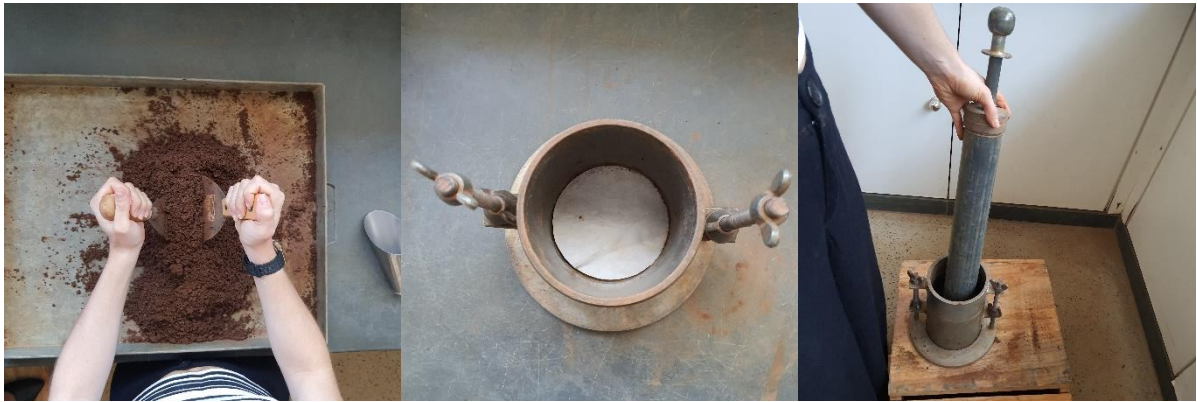
Figura 15 - Homogeneização da amostra (esq.), papel filtro colocado no interior da fôrma (centro) e compactação da mistura (dir.).
