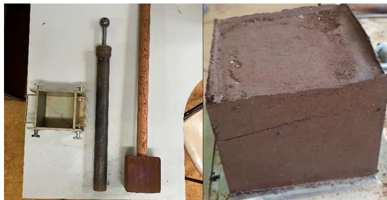
Figura 20 – Fôrma, soquete e compactador (esq.) e corpo de prova sendo desmoldado(dir.).
