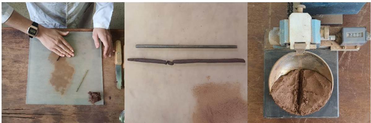
Figura 12 – Ensaio de plasticidade (esq.), amostra para limite de plasticidade (centro) e aparelho para determinação do limite de liquidez (dir.).
