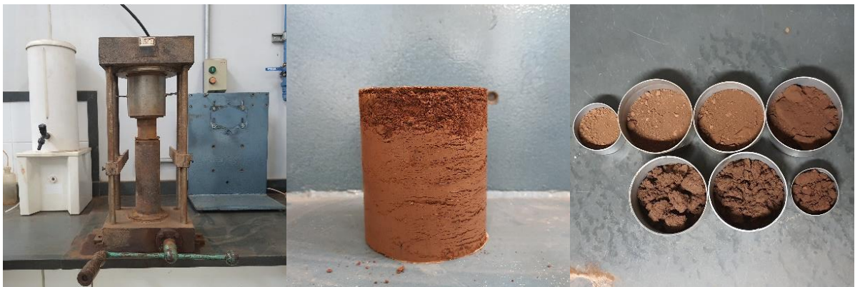
Figura 16- Extrator de corpo de prova (esq.), corpo de prova (centro) e teores variados umidade de compactação (dir.)
