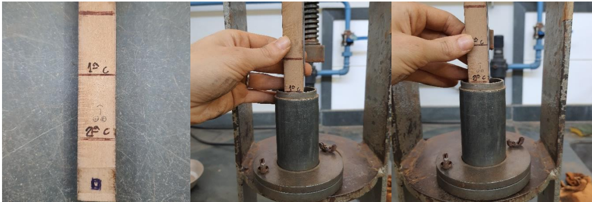
Figura 22 - Régua para aferição da altura (esq.), régua na primeira camada (centro) e régua na segunda camada.
