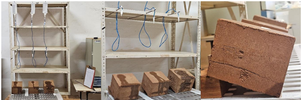
Figura 28 - Sistema para gotejamento (esq.), gotejamento (centro) e inclinação do corpo de prova (dir.).
