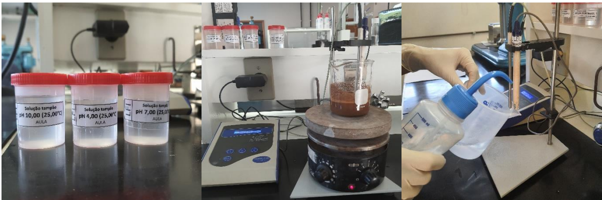
Figura 14 - Soluções tampão (esq.), leitura do pH com agitador magnético (centro) e limpeza do eletrodo (dir.).
