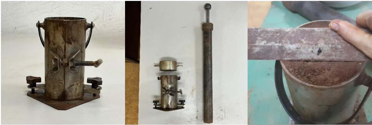
Figura 17 - Fôrma cilíndrica (dir.), fôrma, colarinho e soquete grande (centro) e nivelamento da superfície do corpo de prova (esq.).
