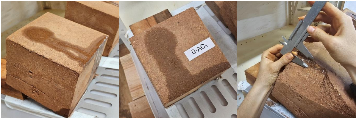
Figura 35 - Misturas após o ensaio de gotejamento – Misturas do Grupo 3.
