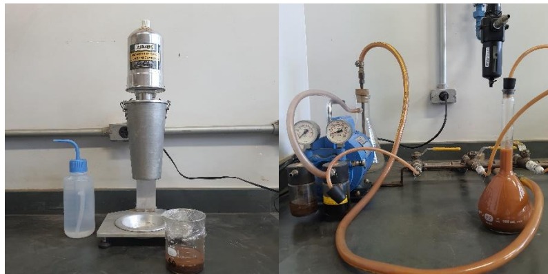
Figura 13 - Copo dispersor (esq.) e amostra em picnômetro submetida ao vácuo (dir.).
