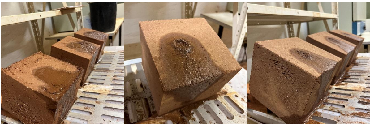
Figura 34 - Erosão final do ensaio de gotejamento – Misturas do Grupo 2.
