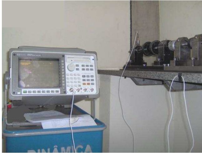
FIGURA 2.6 – Conjunto completo de testes com acelerômetro e analisador de frequência.
