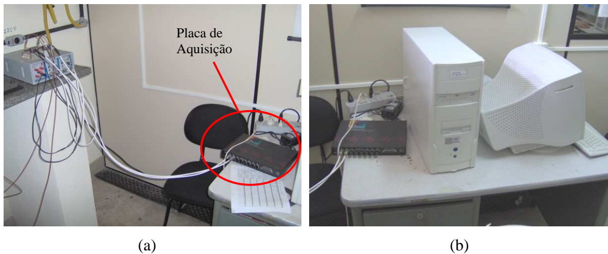
FIGURA 2.10 – (a) Demodulador e placa de aquisição e (b) placa de aquisição e computador.
