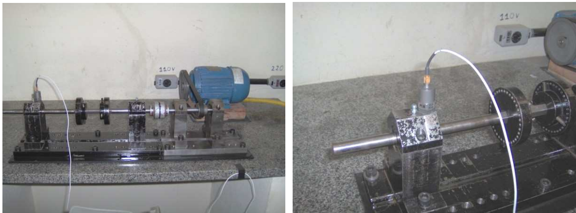
FIGURA 2.5 – Fotos da fixação do acelerômetro na posição A1.
