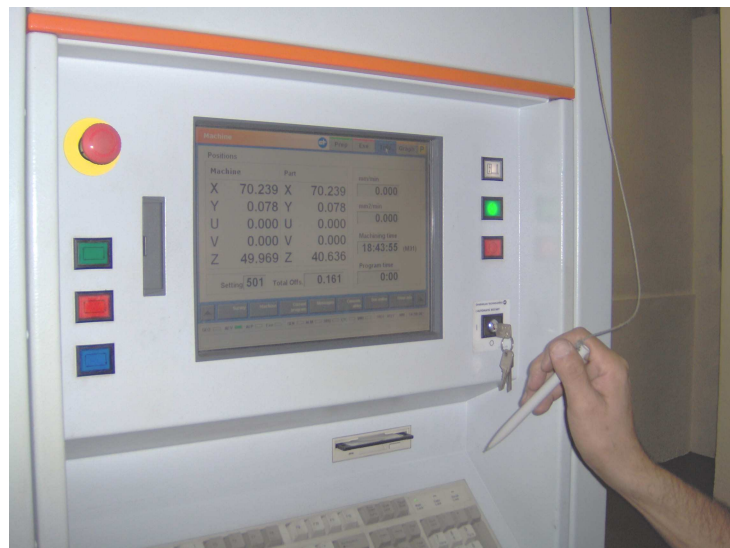
FIGURA 2.14 – Introdução dos comandos para produção dos mancais.
