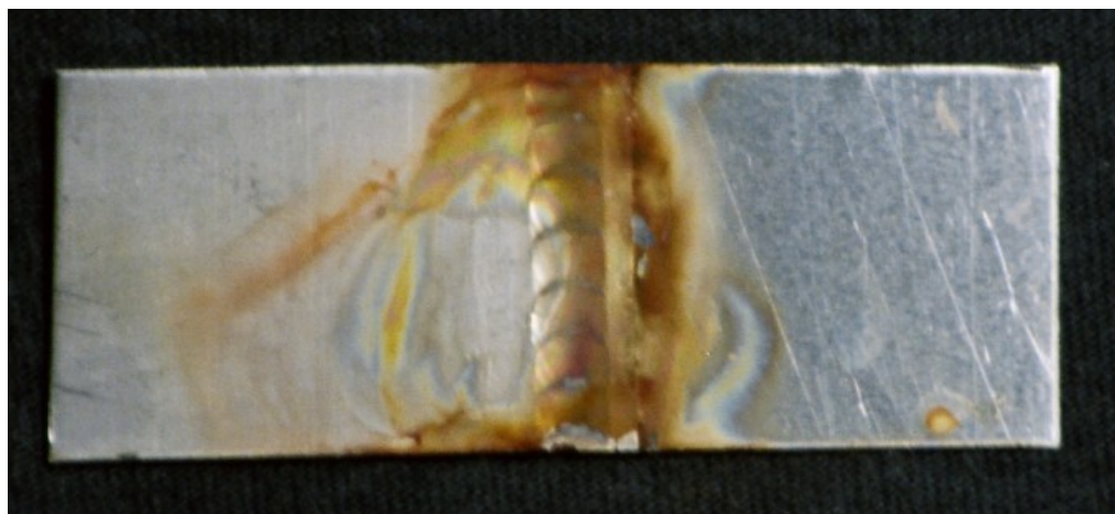
FIGURA 4.4 - Amostra 1 – Par 444/304 1:1 após ensaio de imersão em solução aquosa de NaCl 3% com ciclos de temperatura
