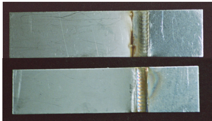
Foto 3 Amostra 1 – Par 444/304 1:2 Ensaio de imersão em NaCl 3% - Temperatura: 60°C
